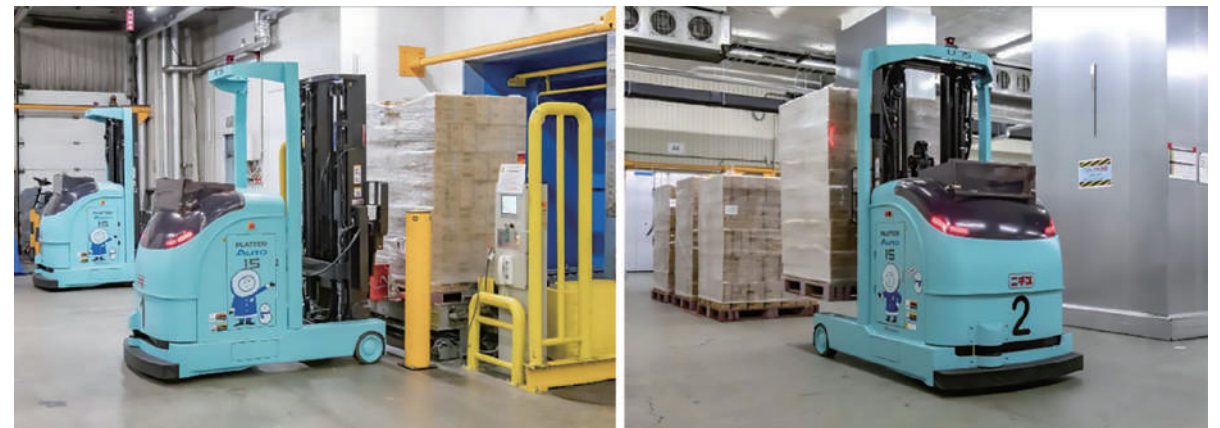
冷凍倉庫内で稼働するレーザー誘導方式無人フォークリフト「PLATTER Auto」
