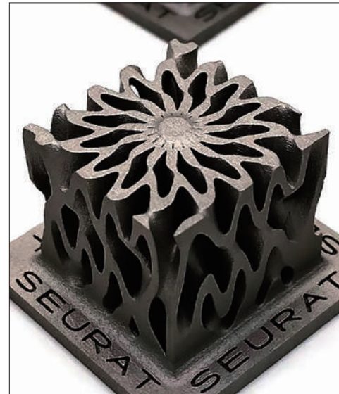
金属用 3D プリンターの加工品。複雑な形状や異素材の加工を可能にする技術が期待できる
