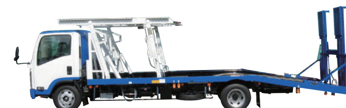
小型ベース 2台積み運搬車 (後柱昇降式、WB延長改造車)
