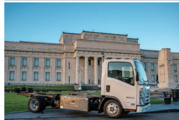
(写真Ⅸ-3) SEA-Drive® 100c型キットw組み付けたISUZU Nシリーズ車シャシの状態
