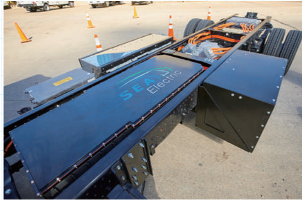
(写真IX-11) SEA-Drive® 180a 型キットを組み付けた緒方バン型車。当社の改造 EV 事業に取り組んだ初期の車の例
