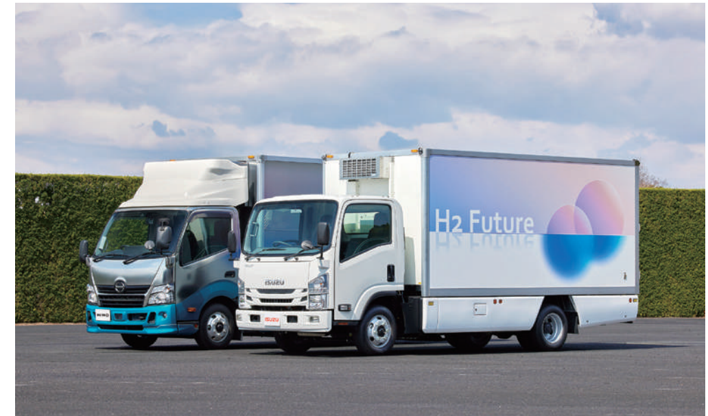
配送用として導入される水素を燃料とする燃料電池(FC)トラック
