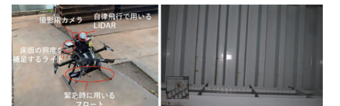
大型ドローン(左)と大型ドローンで撮影した画像(右)
