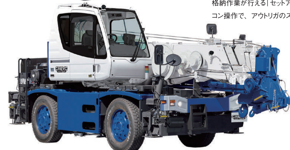
市場ニーズに応え 2 ウインチ仕様を新設定したラフテレーンクレーン「GR-130NL / N(2W)」
