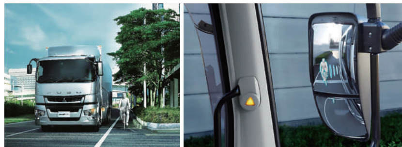
左死角に隠れた危険を警告する安全装置「アクティブ・サイドガード・アシスト 1.0」
