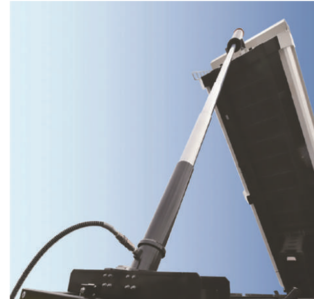
テレスコ式シリンダをダンプ機構に採用したことで重量バランスを最適化
