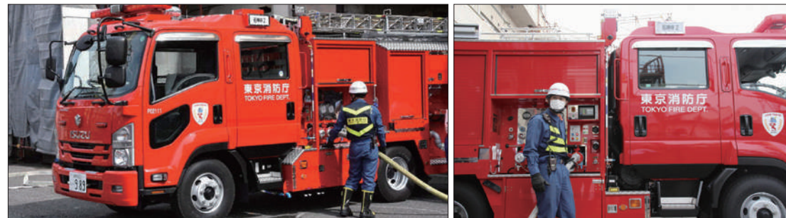
東京消防庁石神井消防署で行われた電動モーターのポンプ駆動による放水テスト
