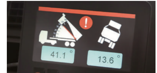
ダンプ角と傾斜角の状態を検知して警告するダンプ横転警告システム(キャブ内モニター)
