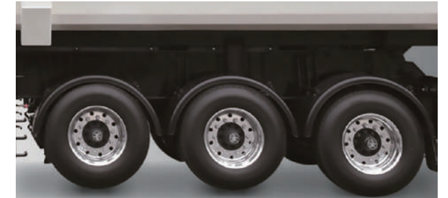
空荷輸送時の 1 軸走行を可能にするエアサスペンション・リフトアクスル
