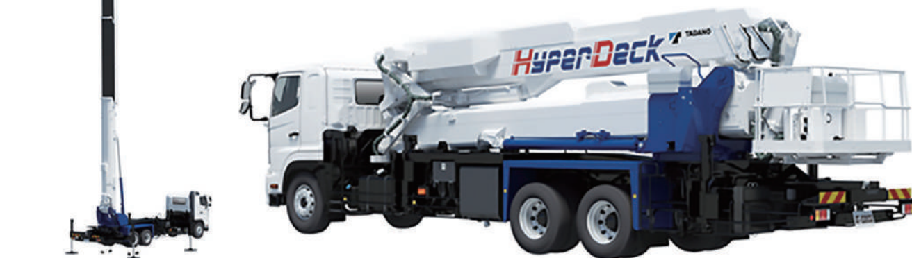
国産最大の地上高と作業半径を誇る高所作業車「ハイパーデッキ AT-530CG」
