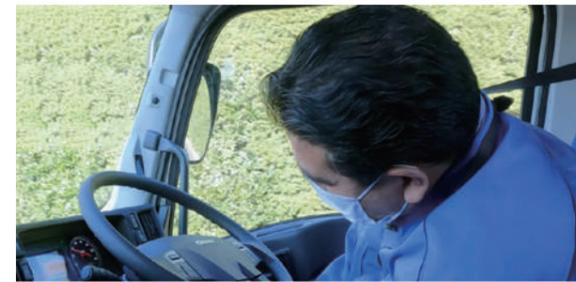
ドライバーの異常な運転姿勢を検知するとシステムが作動し緊急停止する
