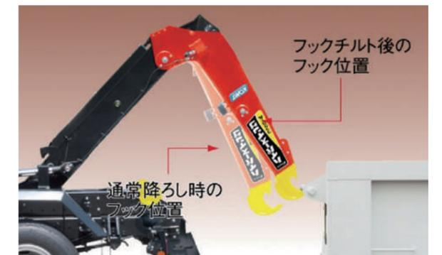
フックを後方約275mm・前方約80mmチルトさせることが可能な「フックチルト」(写真は4トン車)
