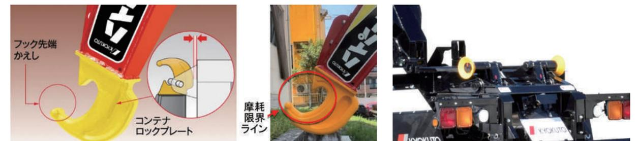
安全で確実なコンテナ脱着を可能にするフック形状
