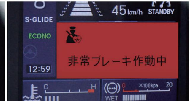
ドライバーの反応がない場合「姿勢を正して下さい」と表示され弱いブレーキが作動する。その後、音声警報と警告画面が表示され強いブレーキが作動する
