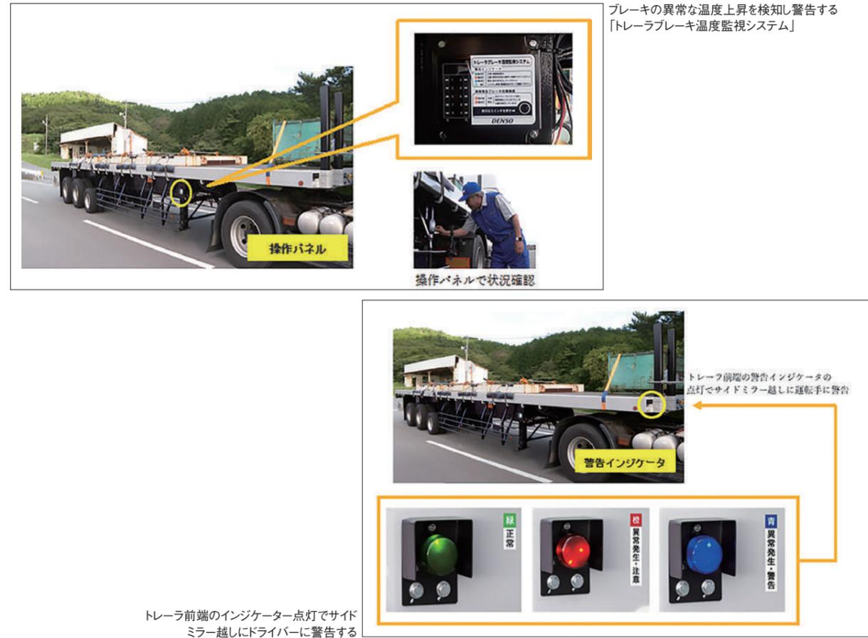
トレーラ前部のインジケータ点灯でサイドミラー越しにドライバーに警告する
