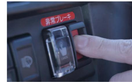
自動作動の他、ドライバー自身がスイッチ操作すると車両を緊急停止させることも可能となっている
