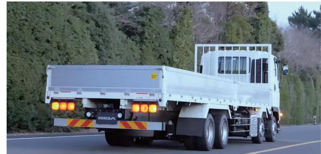
緊急停止した場合は、ホーンを鳴らしハザードランプとブレーキランプを点滅させることで異常事態を車外に知らせる
