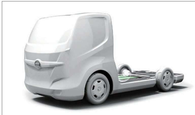
「人とくるまのテクノロジー 2018」に参考出品された日野の小型 EV 商用車プラットフォームの原寸モデル。これがデュトロ Z EV 開発のベースとなっている
