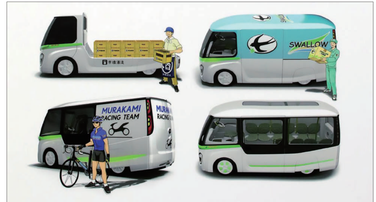
今後はウォークスルーバンの他に用途に応じた荷台を架装できるキャブシャシ型も設定することになっており、ユーザーのビジネス形態に合わせたボデー架装を選ぶことも可能となる(架装イメージ図)
