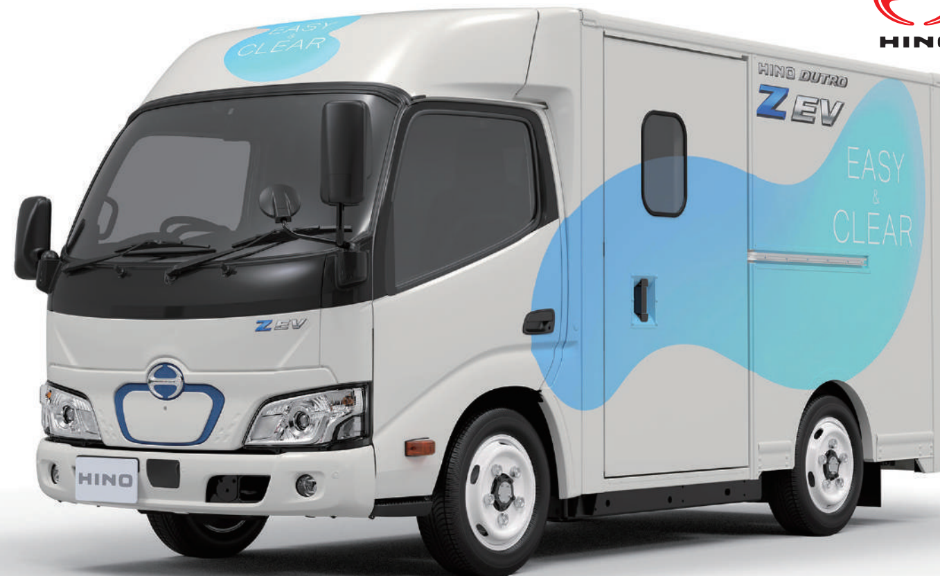
物流現場における使い勝手とカーボンフリーを両立する思想が採用されたウォークスルータイプの超低床タイプ前輪駆動小型EVトラック 「日野デュトロ ZEV」
