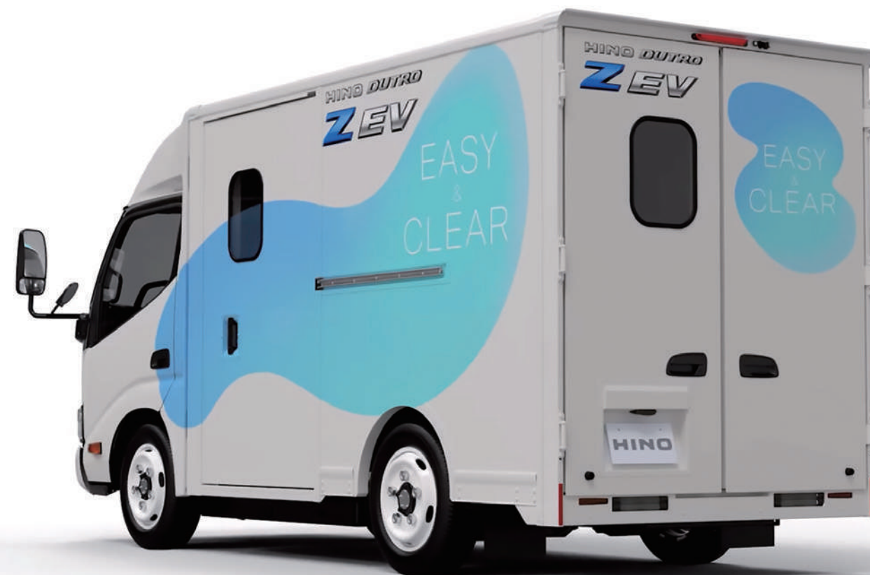
床面上高を従来車の半分の約400mmとしている。この超低床構造により荷役作業性や乗降性を大幅に向上させ、 ドライバーの負担を軽減させている
