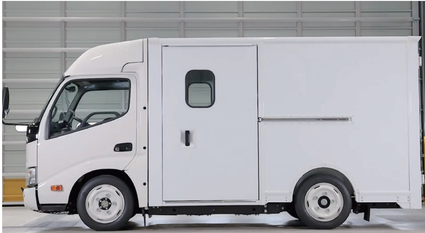
超低床構造と合わせてウォークスルータイプとしたことで、ドライバーは運転席から荷室内を抜け左側扉からの乗降も可能で安全性を高めている
