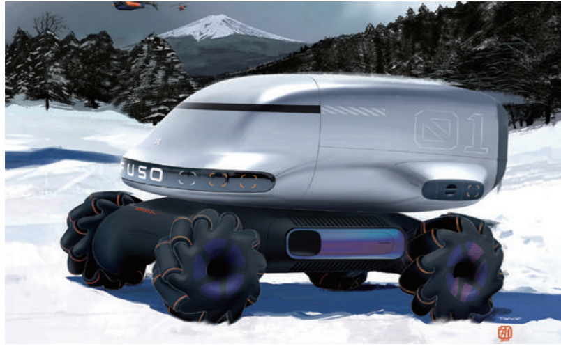
現行の小型トラック「キャンター」の高床式 4WD モデルから着想したモジュールトラック「I.R.Q」。自動運転機能を搭載した燃料電池で駆動する緊急車両のコンセプトモデル
