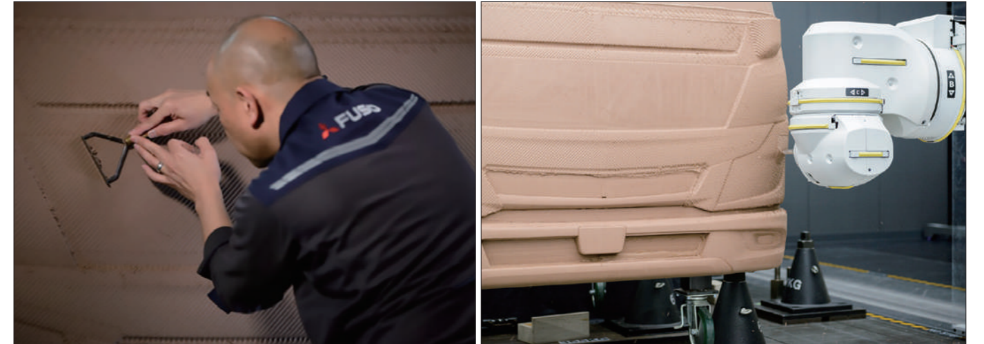
フィジカルデザインプロセスでのクレイモデルは、日本人モデラーの伝統的な職人技術と最新データのモデリングによる3Dプリントや数値制御データによるNC切削などの技術が融合されている
