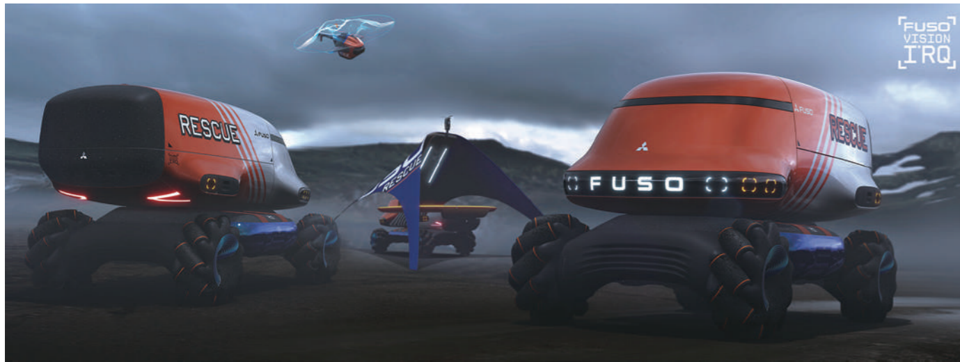
現行の小型トラック「キャンター」の高床式 4WD モデルから着想したモジュールトラック「I.R.Q」。自動運転機能を搭載した燃料電池で駆動する緊急車両のコンセプトモデル
