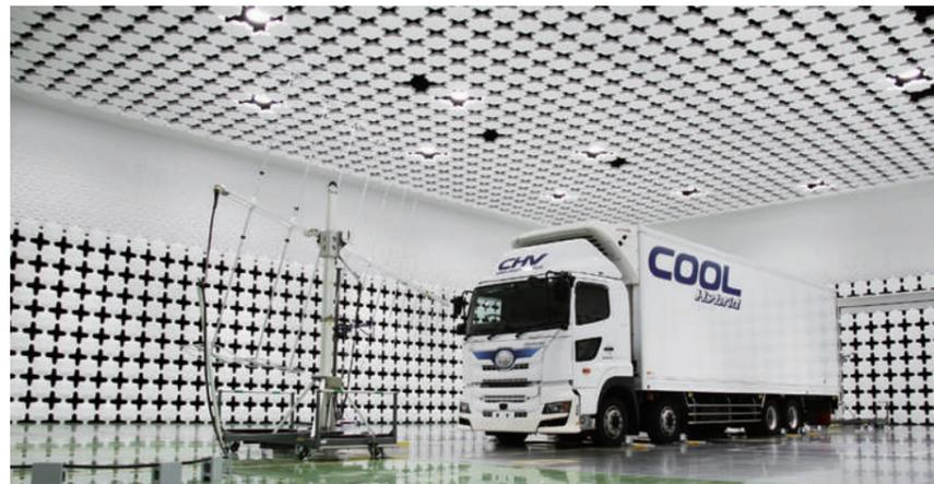
乗用車から大型トラック・バス、建設機械等にも対応可能な世界最大級の電波暗室
