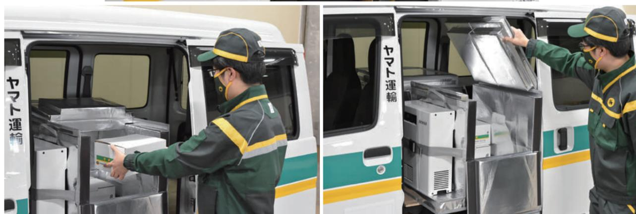
使用用途や荷量に応じて組み合わせる断熱箱の寸法が選べるため、温度管理を必要とする食品や医薬品、冷蔵・冷凍品の小口多頻度配送などに柔軟に対応できる
