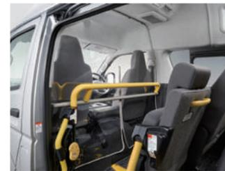
車いす仕様車Bタイプに装着された「飛沫・セパレータ」の下部固定ボタン
