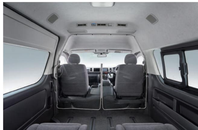
グランドキャビン(ハイルーフ仕様)に装着された「飛沫感染対策セパレータ」
