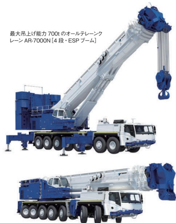
最大吊上げ能力700tのオールテレーンクレーン AR-7000N [4段・ESPブーム]
