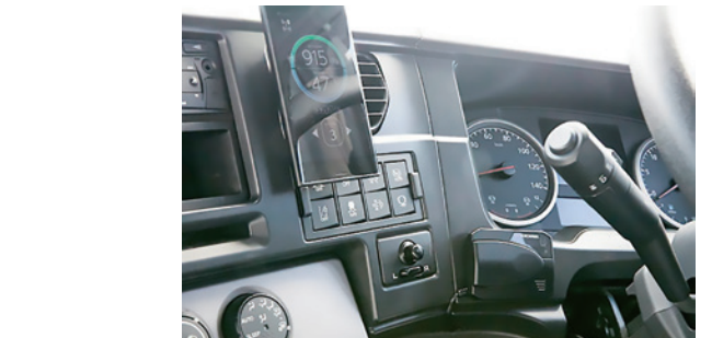
空気圧管理システムの「HiTES」はタイヤ内部の空気圧と温度をリアルタイムで確認することでトラックの安全運行に貢献する
