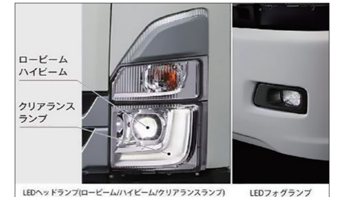
より遠くまで明るく照らすLEDランプの採用でハロゲン式より省電力でランプ寿命も向上させている
