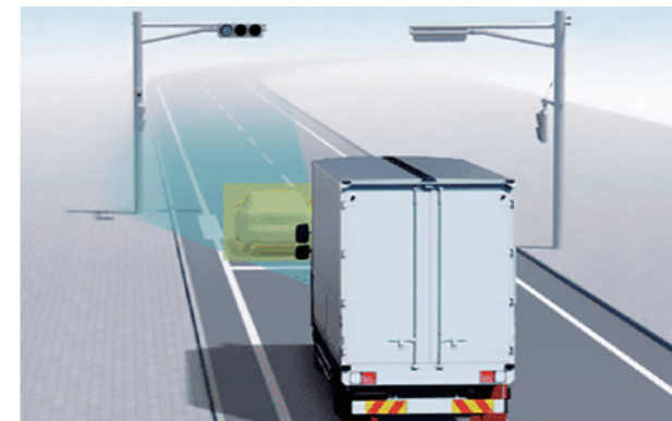
先行車が発進しても自車の発進操作が無かった場合に警報音で発進を促す「先行車発進お知らせ機能」
