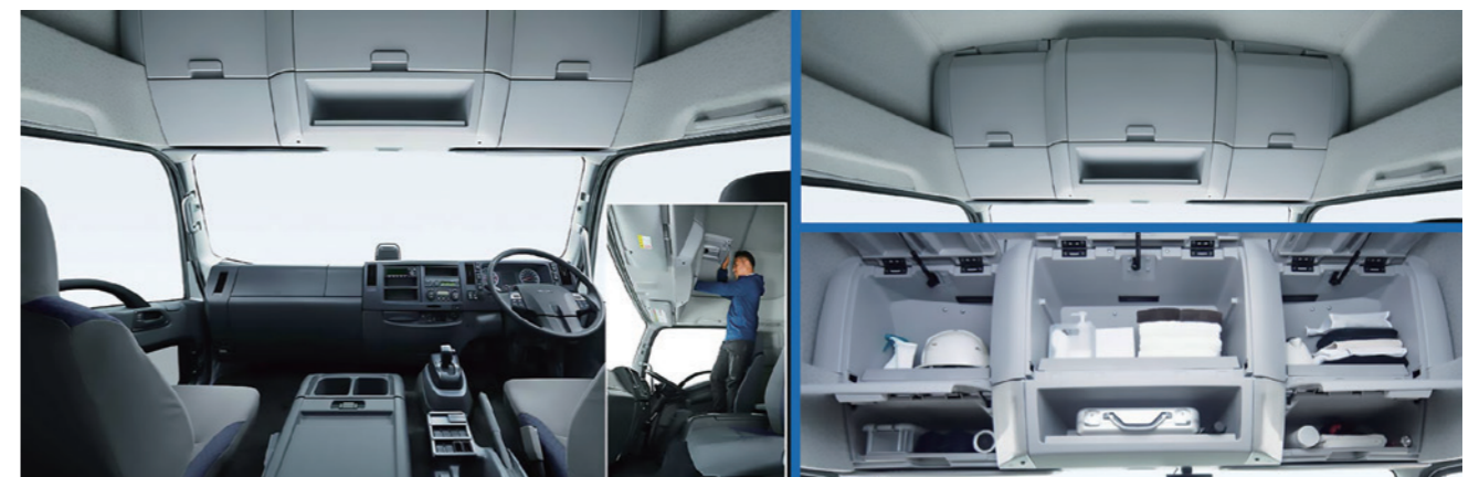
大型ヘッダーコンソールを備えた新ハイルーフには大容量の収納スペースが確保されている
