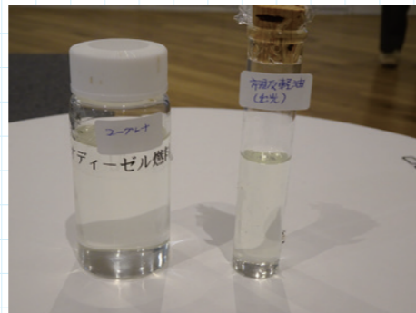
(写真 3) ユーグレナと市販軽油の性状(外観)比較 (混合前の両燃料外観比較: 筆者撮影)
