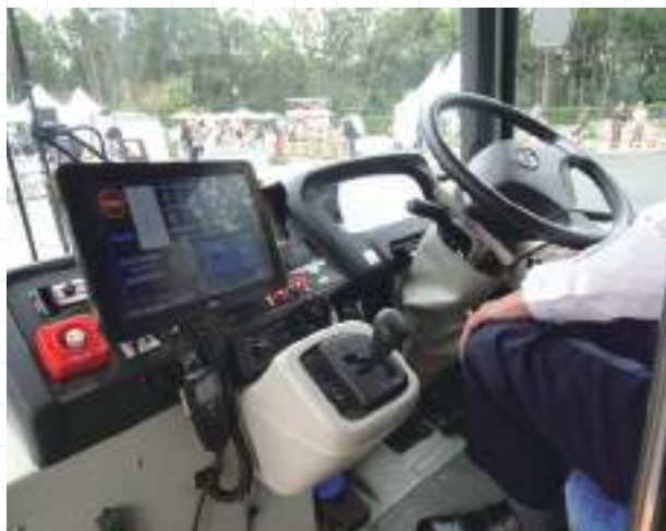
〈有人〉運転中の運転席まわり。チェンジレバー操作も自動だ
