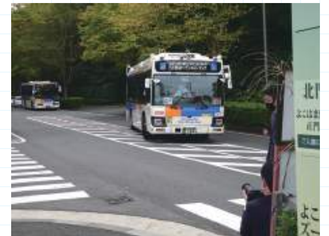
「連絡道路」から右折して停留所へ入る前に、一時停止した(無人)自動運転バス。後続車は標準仕様の路線バス
