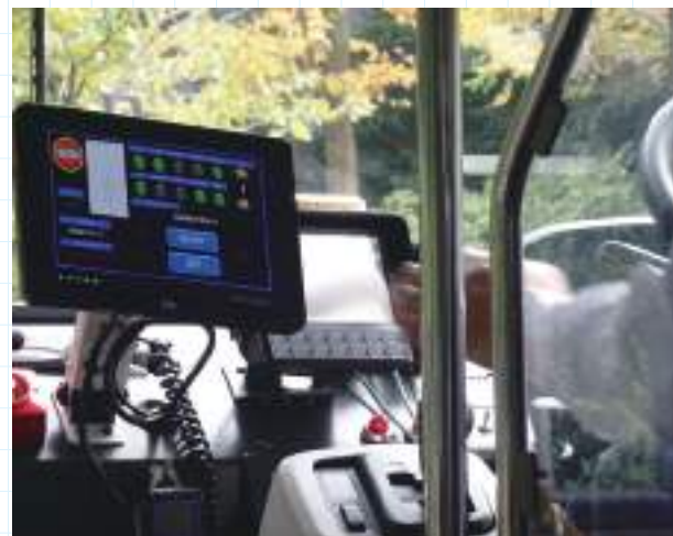
特設されたタッチパネル(手前)と車両の後方を表示するモニター
