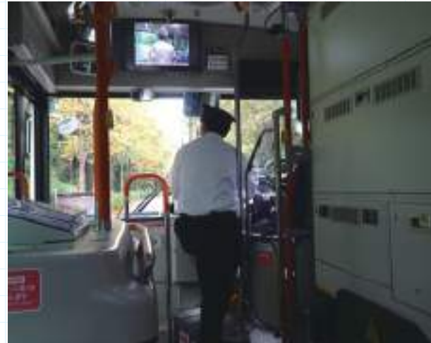
右側の大きなケース内は制御系装備用だ 車内最前席から〈無人〉状態で通路に立つ保安者の動きも観察できる
