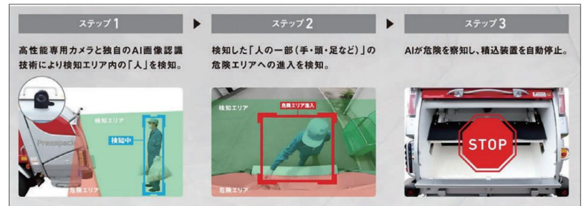
また、「人」全体を把握して検知を行うことから、特別な専用装備を必要とせず作業者はもちろん、作業員以外の人物の検知を行うことができる。さらに、「KIES」作動履歴の保存や、同社のIoT基盤を利用した車両管理支援システムである「K-DaSS(ケーダス:Kyokuto Data Sharing Service)」との連携も可能としており、さらなる安全管理の徹底を実現する。極東開発グループは、収集時の作業性を損ねることなく、
