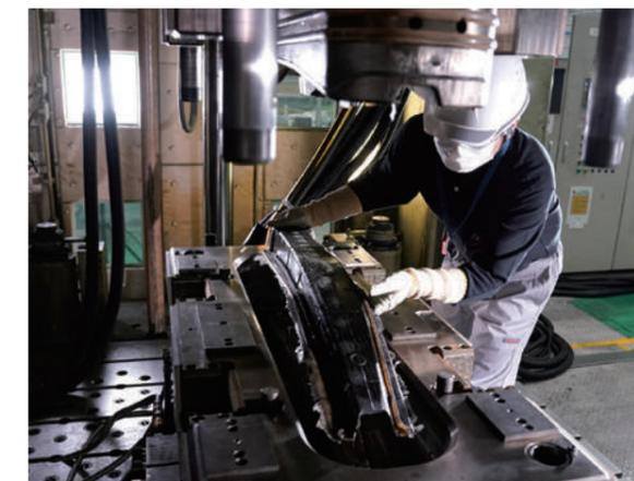
炭素繊維への樹脂の含浸度合いを正確にシミュレーションする技術で成形時間を短縮
