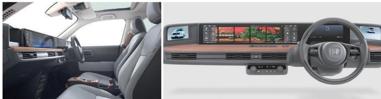
5つのスクリーンを水平配置する世界初のワイドビジョンインストルメントパネルが採用されている
