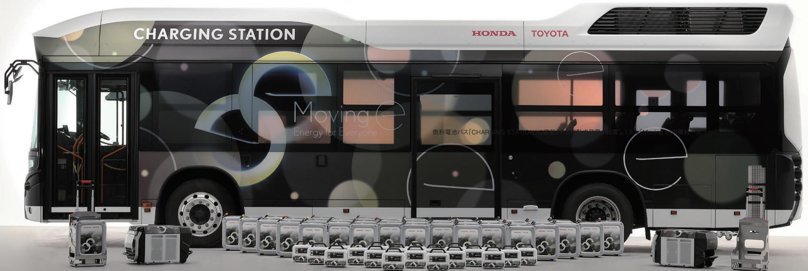
燃料電池バス「CHARGING STATION」に搭載される移動式発電・給電システム「Moving e」の機材一式
