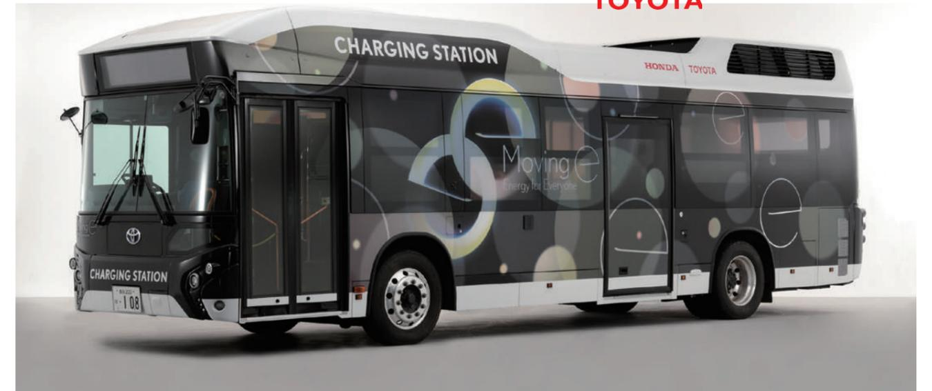
「トヨタFCバス」をベースに高圧水素タンク本数を倍増し水素搭載量を大幅増加させた燃料電池バス「CHARGING STATION」
