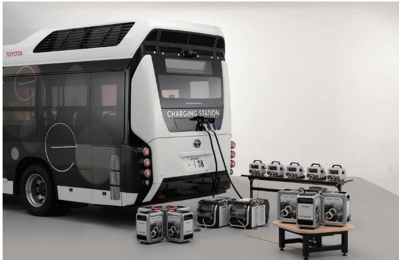
「CHARGING STATION」が発電した電気を可搬型の大容量バッテリーに充電する様子
