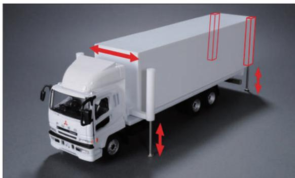
⇨ 脱着ボディの前方は左右に伸びるジャッキと上下昇降油圧シリンダー、コンテナ後方は油圧シリンダーをコーナーポストに組み込み、電動油圧システムで作動します。
