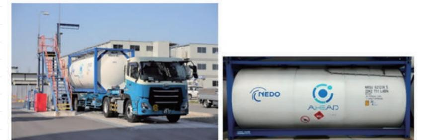
輸送は ISO 国際基準タンクコンテナを利用する。海陸一貫輸送に適正している (出所: NEDO)
