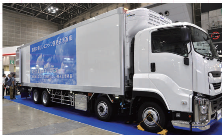
冷媒ヒートポンプ加温技術を採用した「GBS 冷却／加温機能付き中型冷凍車」（右）。品温の異なる商品を混載輸送できる2エバ冷凍装置搭載の先進的な車両だ
