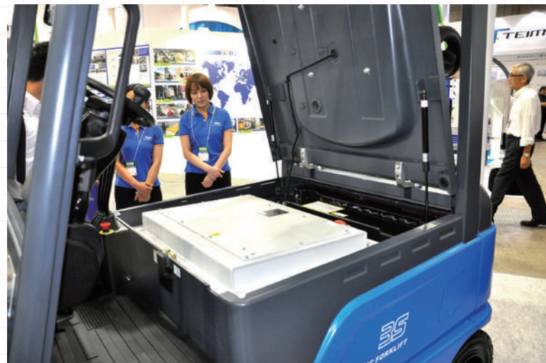
BYDの電動フォークリフトに搭載されている高性能リチウムイオン電池
