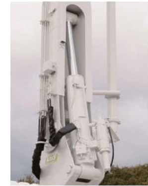
クラス最長のロングストロークシリンダを装備したポンプユニット
