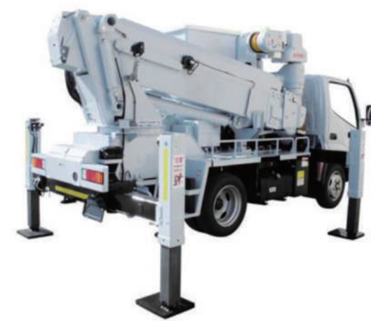
配電工事用省スペース高所作業車「SN13A1FS」
