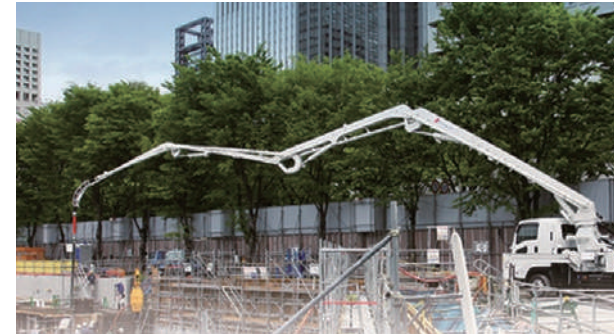
軽量化を実現した 33 メートル級 M 型4段屈折ブームを搭載
