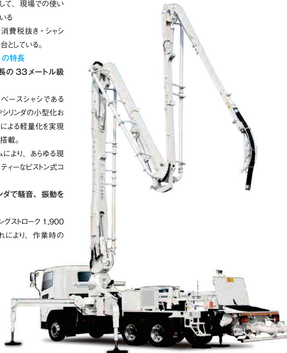
33メートル級ブームを搭載した「ピストンクリート PY120-33C」
