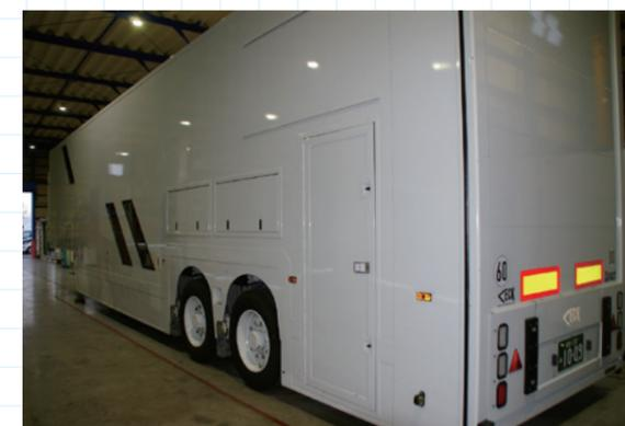
車両輸送分野に投入しているECKファンエック社製低床可動2段フロア式セミトレーラ。スーパーカーの輸送にクローズド型ボディは欠かせない選択だが、国産車で当社の要求スペックに見合うものは現在ない(筆者撮影)
