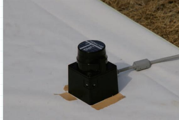
異物侵入検知センサー兼ドローン誘導装置
