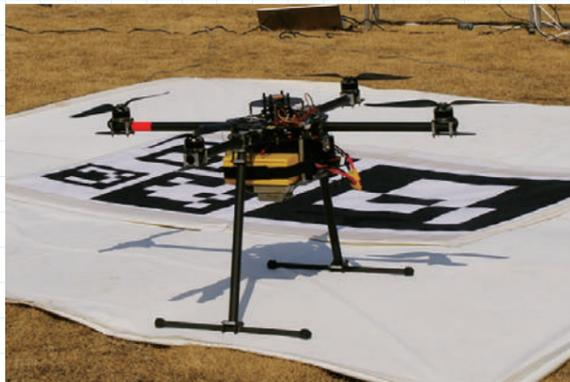
自律飛行機能の実証実験用に準備され飛行する当日のドローン(ローンはブルーノベーション社製)。機体は寸法: 縦 1m × 横 1m × 高さ 0.58m、重量約 2kg、最大積載重量約 1.5kg。積載装置、積載重量など物流用には目的に応じて別途検討が必要である
