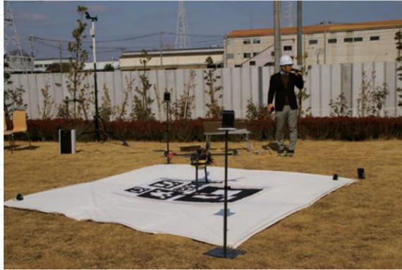
GPS による自律飛行も想定して飛行経路の発地点・着地点双方に 3m の白色キャンパスの中央に同じパターンを設置したドローンポート。異物侵入検知センサー兼誘導電波発信機が 3 か所の隅に置かれていた
