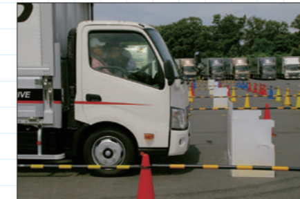
前方の障害物まで 45cm 程度に接近すると図形が現れ断続警報音が発せられ・・・
