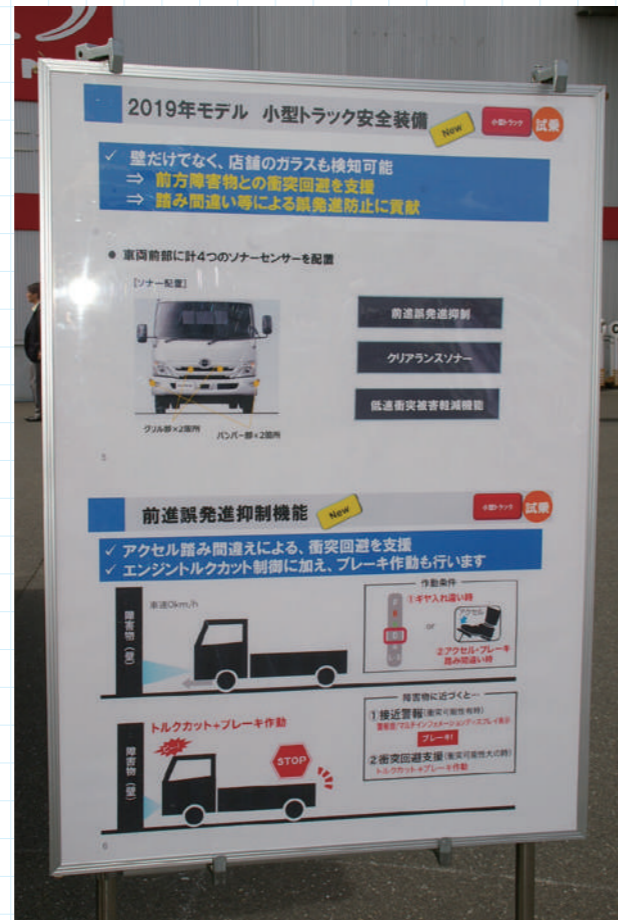
試乗の当日、小型トラック「日野デュトロ」に装備されていたのは、1 前進誤発進抑制機能、2 低速衝突被害軽減機能、3 クリアランスソナー等だった。いずれも 2019 年モデルの市販車に搭載されている
