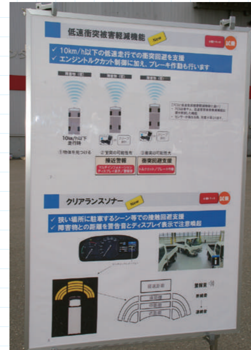
前面には障害物検知用のセンサーが合計 5 箇所に埋め込まれている。内、バンパー中央にはミリ波レーダーの送受信器、が設置された関係で、ナンバープレートは向かって左側にオフセットされた。クリアランスソナーは左右とバンパー左右角の系 4 箇所には超音波(ソナー)センサー、が埋め込まれている。ミリ波レーダーは単独で前面の障害物に対して機能し、超音波(ソナー)センサーは隣接 2 箇所のいずれにも障害物を感知すれば減速システムへ作動開始の信号を送る
