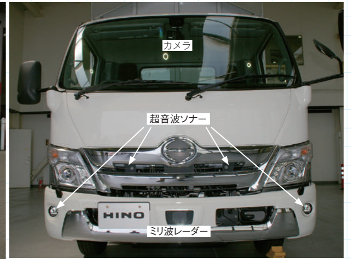
前面には障害物検知用のセンサーが合計 5 箇所に埋め込まれている。内、バンパー中央にはミリ波レーダーの送受信器、が設置された関係で、ナンバープレートは向かって左側にオフセットされた。クリアランスソナーは左右とバンパー左右角の系 4 箇所には超音波(ソナー)センサー、が埋め込まれている。ミリ波レーダーは単独で前面の障害物に対して機能し、超音波(ソナー)センサーは隣接 2 箇所のいずれにも障害物を感知すれば減速システムへ作動開始の信号を送る
