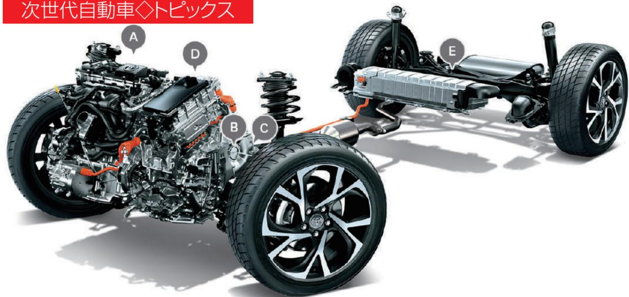
先進のトヨタ・ハイブリッドシステム。A: 2ZR-FXE エンジン、B: ハイブリッドトランスアクスル、C: 高回転モーター、D: パワーコントロールユニット、E: ハイブリッドバッテリー
