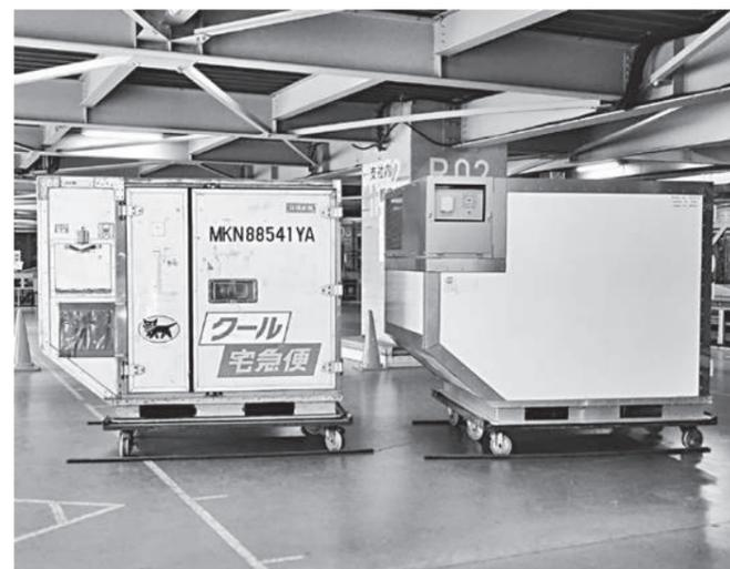
新型航空保冷コンテナの試作品(右)と既存コンテナ
