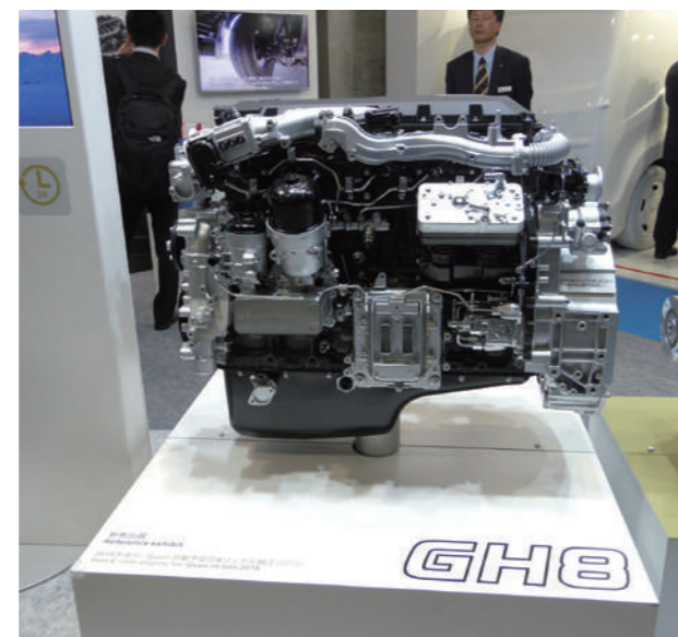
UDトラックス・クオンに搭載されるダウンサイジング GH8 エンジン 《人とくるまのテクノロジー展》
