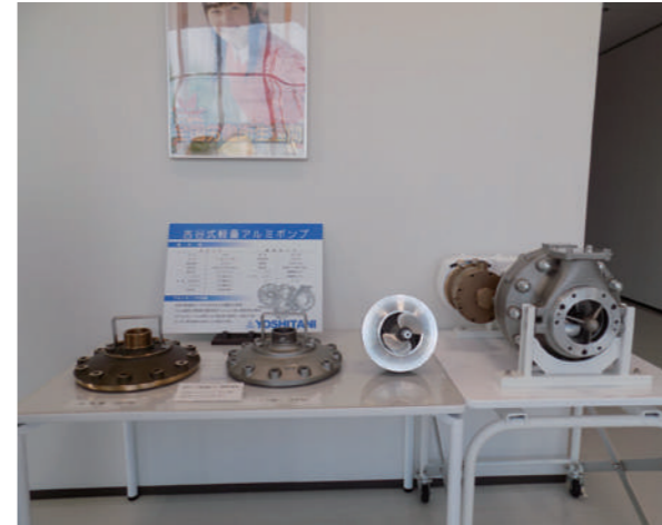
重い旧式ポンプと軽量の最新アルミポンプを比較展示
