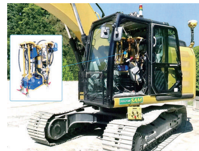
人工筋肉を採用した「SAM」は建機を自在にコントロールできる
