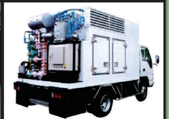
ガスパイプライン工事車
