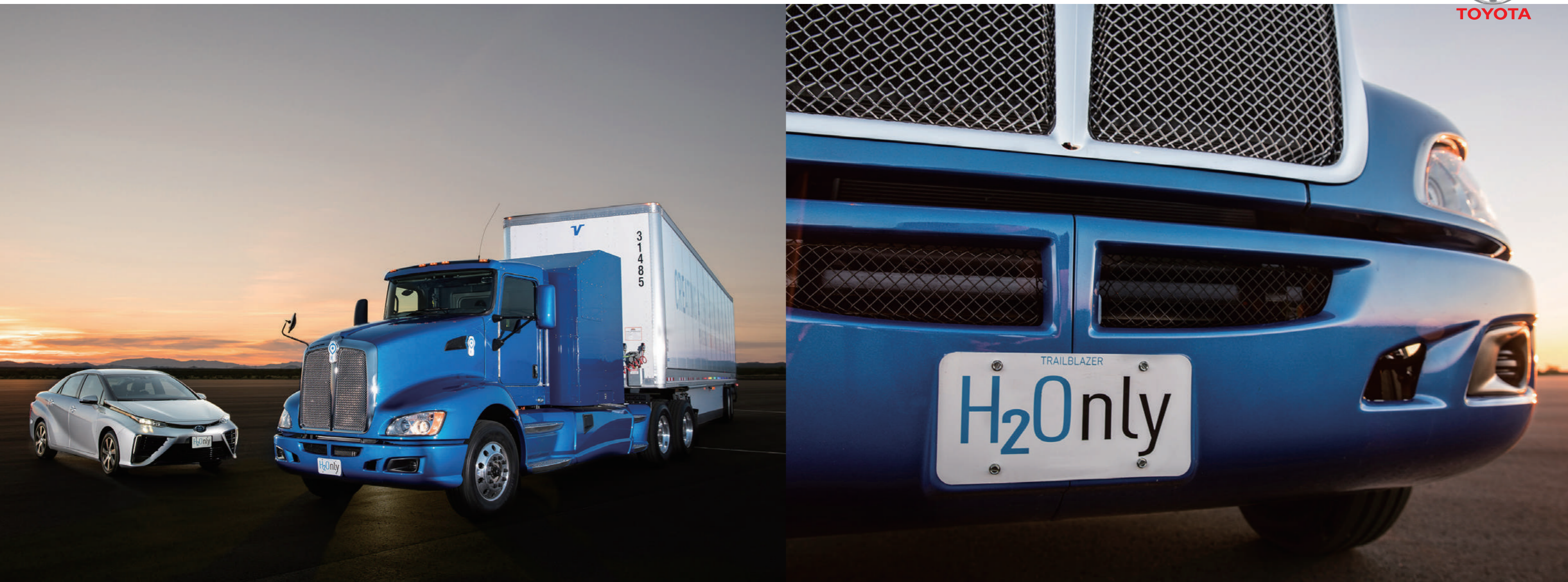
実証実験のFC大型トラックは「MIRAI」のFCスタック2基により約500kWの出力を発生させている
