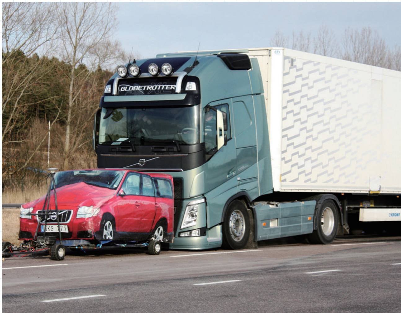
実験車の自動緊急ブレーキは40トン積載のトレーラごとフルストップをかけて、ダミーの僅か数センチ手前で停止した
