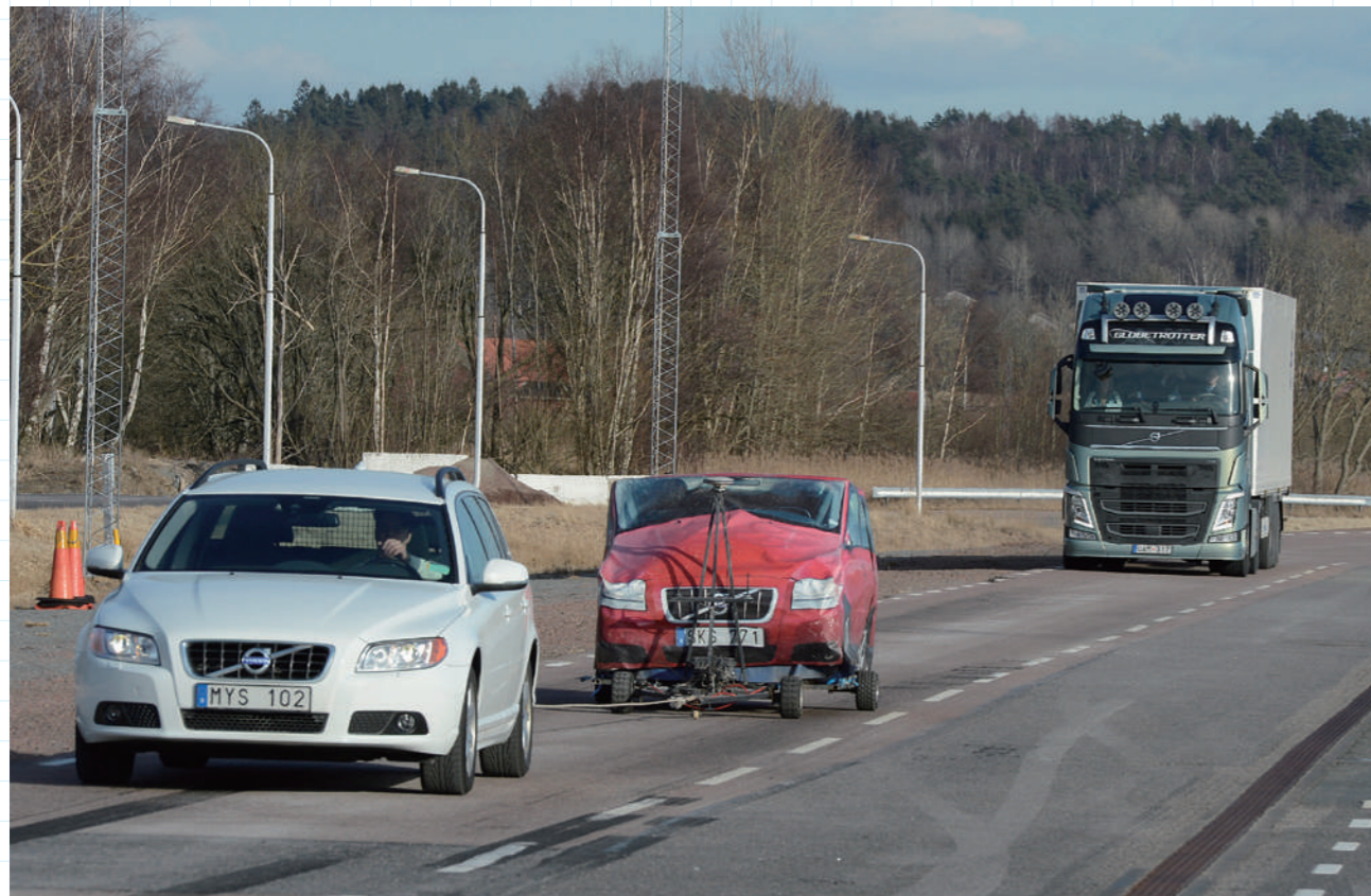
筆者が2013年に自ら体験した当時開発中の非常ブレーキ作動実験の様。前方に徐行するダミー車を検知した実験車は、自動で緊急ブレーキシステムが作動した
