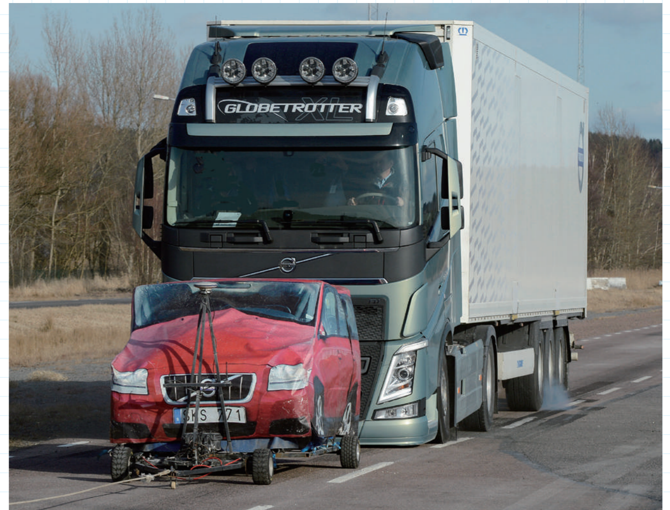
フルストップが作動したトレーラ側のタイヤは路面との間でかすかに発煙していた
