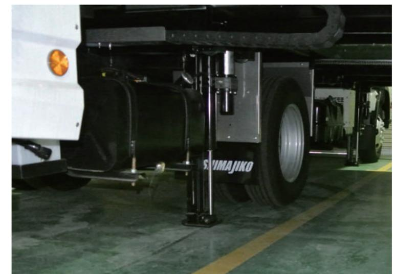
荷台下には拡幅の際に車両を安定させる支持脚が取り付けられている
