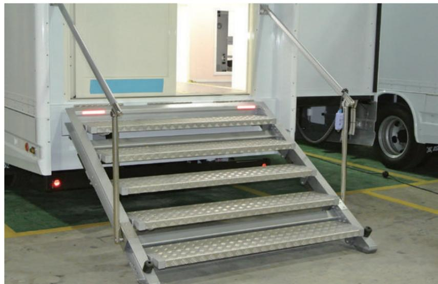
ステップもリンク機構で自動的に開閉する
