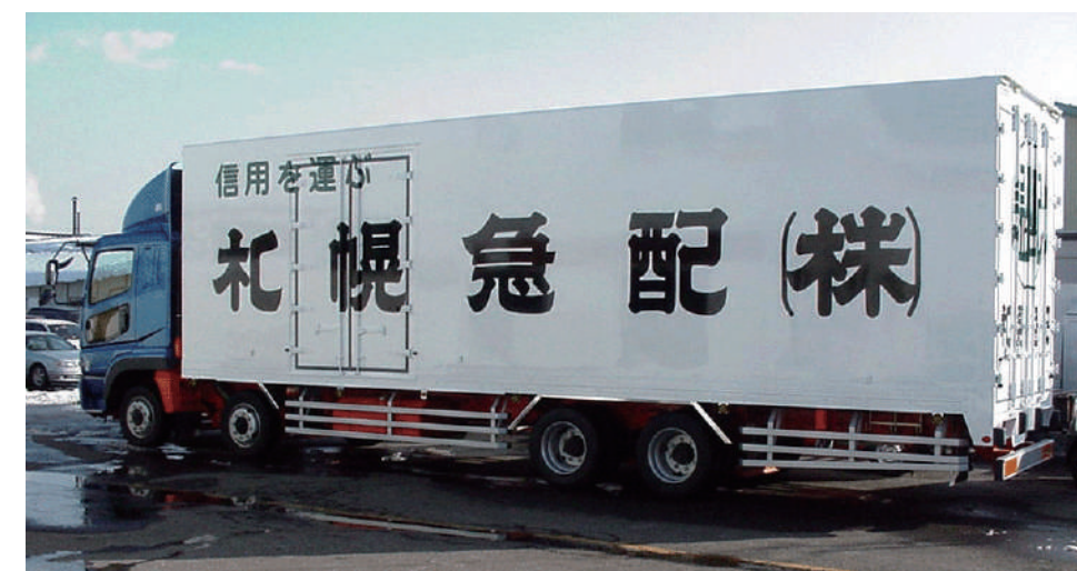
美しく、清潔な「FRP 一体成形バン」。継ぎ目やリベットがないので広告スペースとしても利用価値が高い。錆びない、腐らない、抜群の耐久性で、優れた経済性を発揮する
