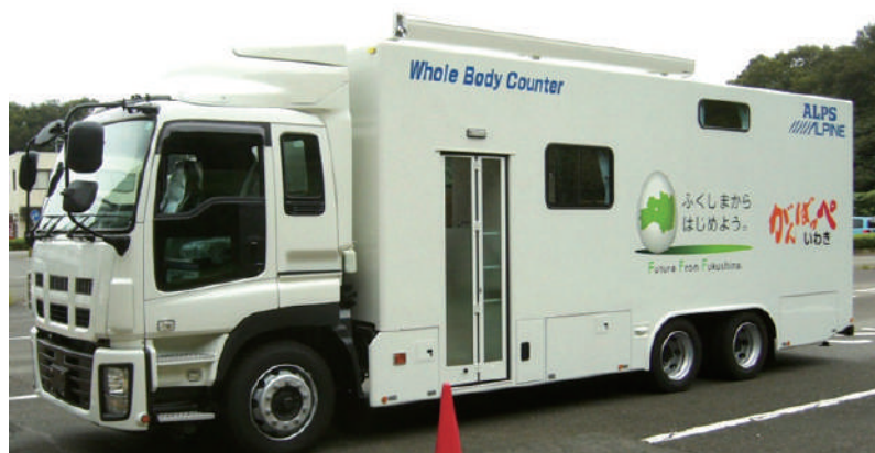
人体の放射能を測定する装置を搭載した「ホールボディカウンター車」
