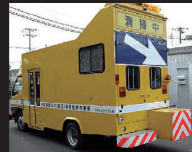
高速道路で活躍する「道路維持作業車」
