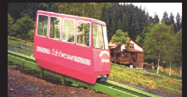
田沢湖スイス村の FRP 製「リフトカー」
