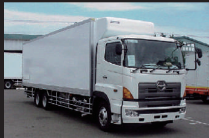
耐久性と断熱性に優れる「FRP サンドイッチバン」(25トン大型冷凍車)
