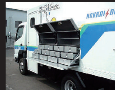
工具類の取り出しを容易にした「移動工作車」
