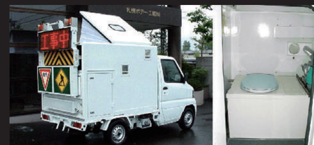
工事現場の悩みを解決するパイオトイレ搭載の「セーフレットII」
