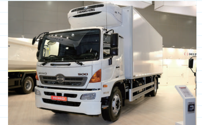
HINO の 500 型。温度管理機に Thermo King を採用した温度管理バン型車
