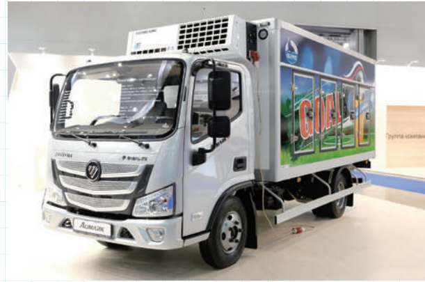
中国の FOTON AUMARK 車。温度管理機は Thermo King が搭載されている
