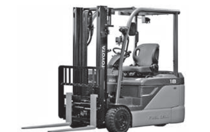
1.8トン積タイプ燃料電池フォークリフト
