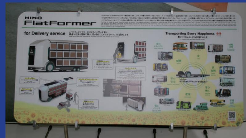
日野が構想する自動化無人運転は、FlatFormer フラットフォーマーの名称だ。台車部分の稼働率を徹底的に追求し、必要な用途毎の上部構造をユニット化して随時換装することを提唱する。勿論、バッテリーによる全電動BEVだ
