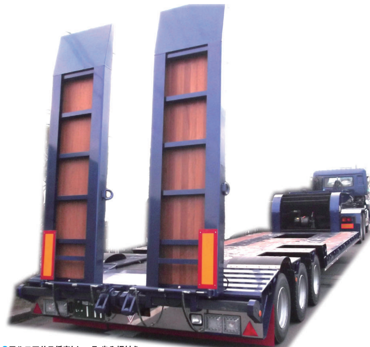
● フルエアサス低床トレーラ 歩み板付き キングピンにエアサスを装備し精密機器の輸送が可能電動油圧式歩み板も装備しているため重機輸送も可能 荷台長 5.4 m 荷台高 60cm 積載量 34t
