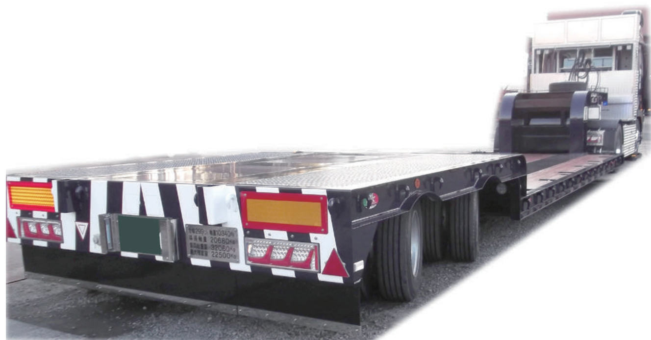
● シングルトレーラで牽引するステアリング低床トレーラ 積載量は 22t ですが狭いところへの運送へは最適 荷台長 6.5 m 荷台高 50cm
