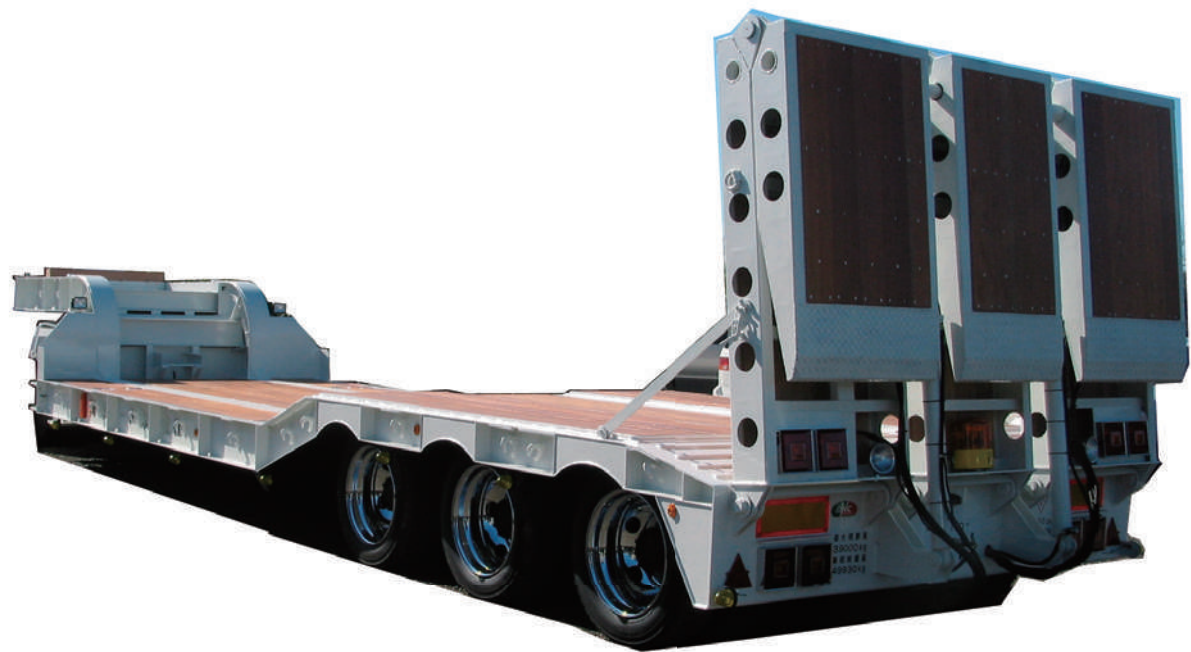
●エアサス重機運搬用低床トレーラ 歩み板付き 電動油圧式歩み板を装備し重機輸送に最適 荷台長 5 m 荷台高 76cm 積載量 39t
