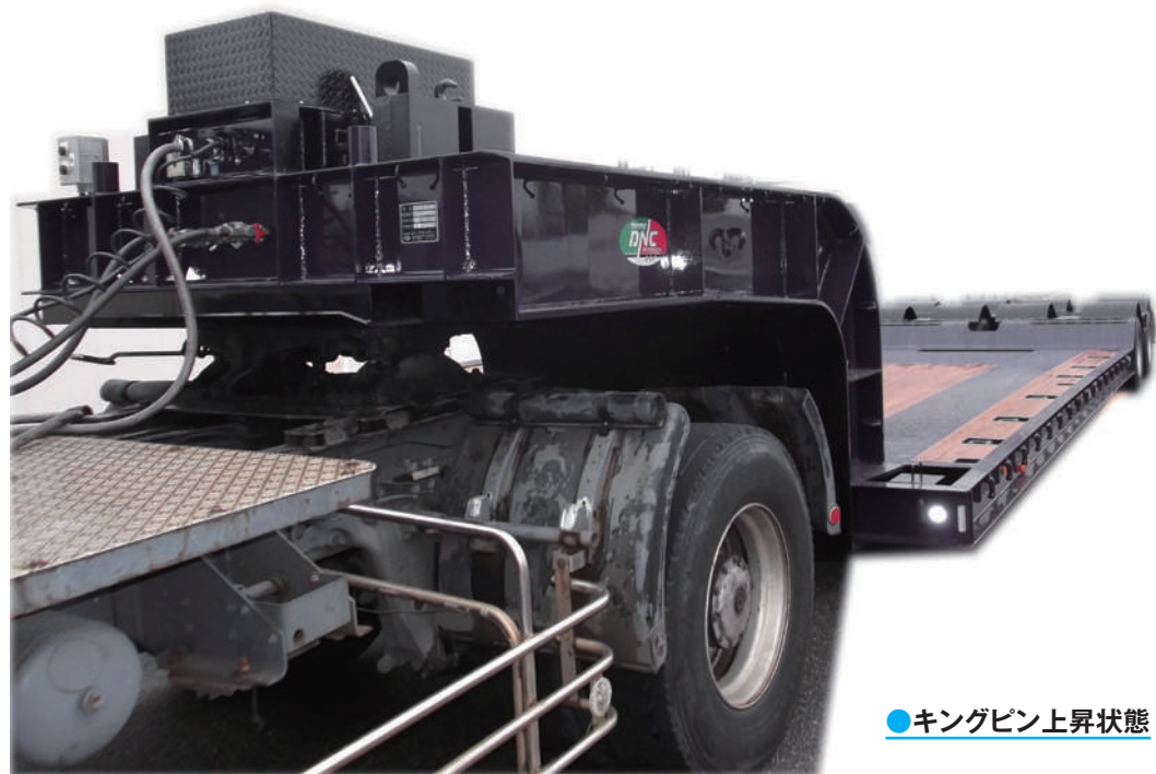
●キングピン上昇装置付 16 輪トレーラ キングピン部に上昇機構 (25cm) を装備 荷台長 6.5 m 荷台高 50cm 積載量 36.5t
