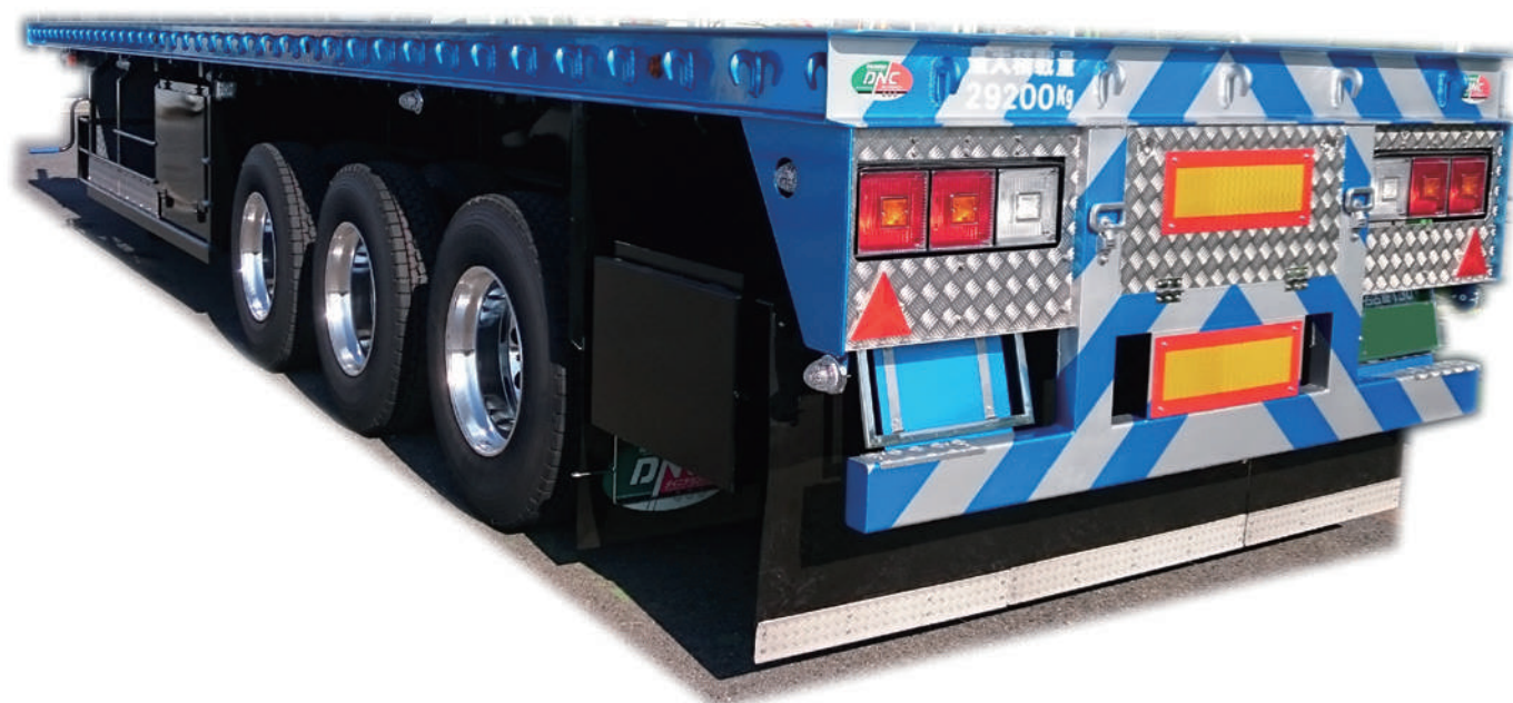
● 高床 12m3 軸トレーラ バラ積み対応 29t 積載仕様
