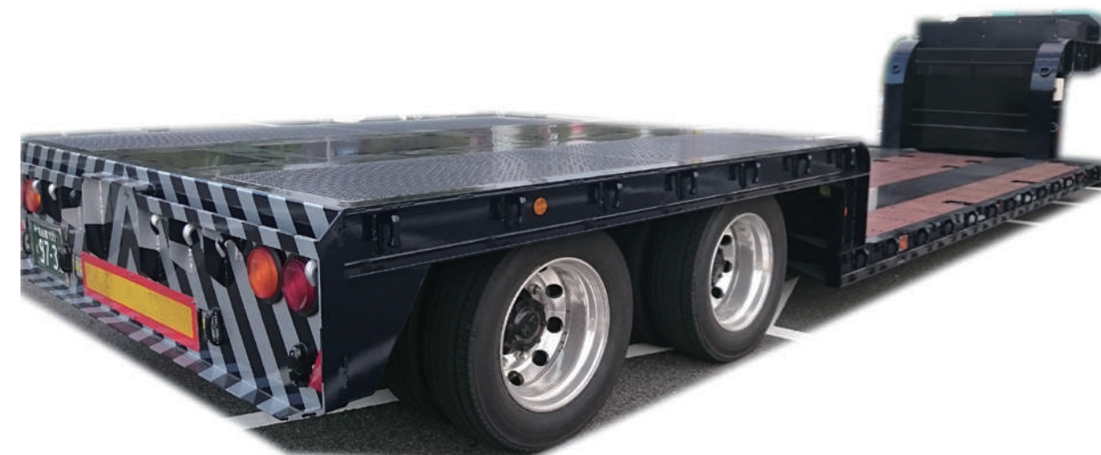
● ステアリングフルエアサス低床トレーラ キングピンにエアサスを装備し精密機器の輸送が可能ステアリングも装備しているためあらゆる所への輸送が可能 荷台長 6m 荷台高 45cm 積載量 30t
