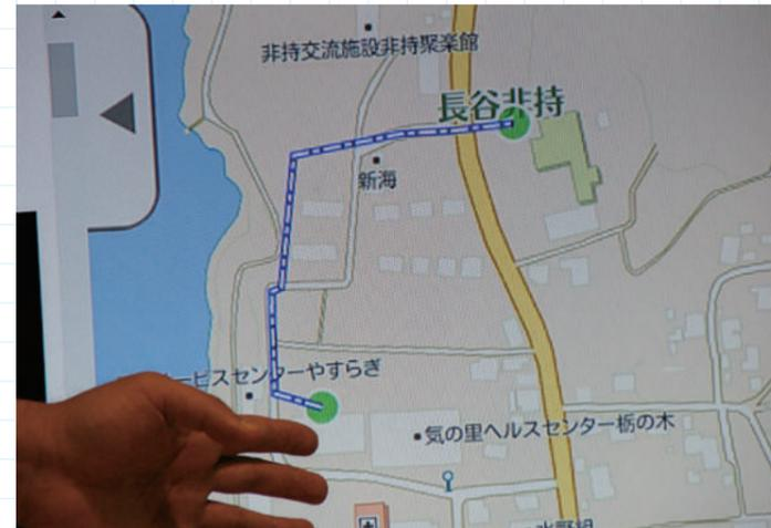
実験飛行ルート図。伊那市長谷地区の道の駅に隣接した「長谷非持交流施設」から「サービスセンターやすらぎ」まで直線距離は約 400m。途中で電線などがあり計画飛行ルートはカギ状になっている。ドローンポートは離陸・着陸両地点に設置された
