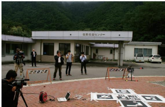
目標地点上空からは搭載されたカメラが地上のドローンポートを認識して誘導する。見事に中心に着陸寸前・・・
