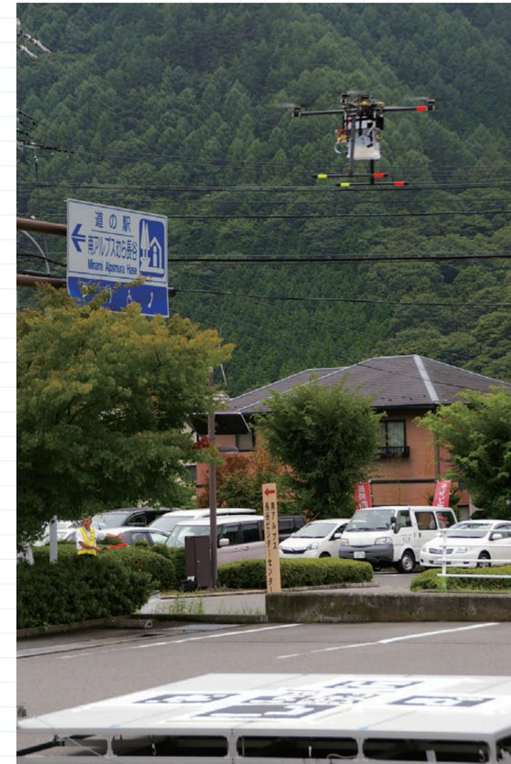
離陸した実験用ドローン。小型でプロペラは4個が電動で約 20 分間飛行可能
