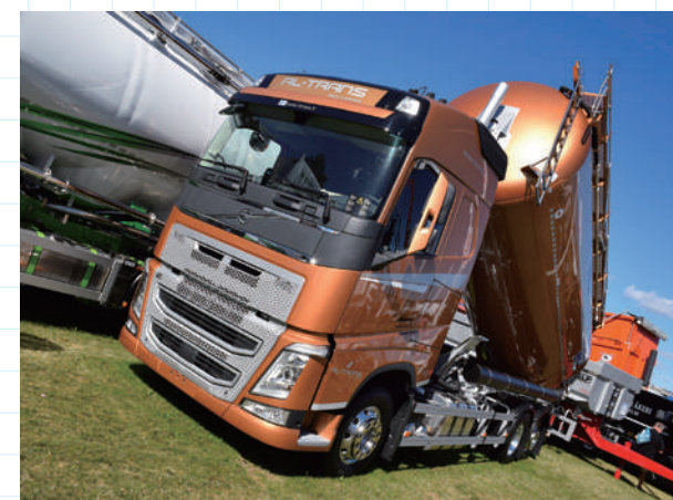
Volvo FH 型単車シャーシに架装されたバルクタンカー車
