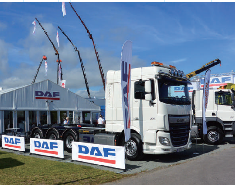
DAF の CF 型後 3 軸車。北欧の基準では単車の総重量が 36 トンまで許容される
