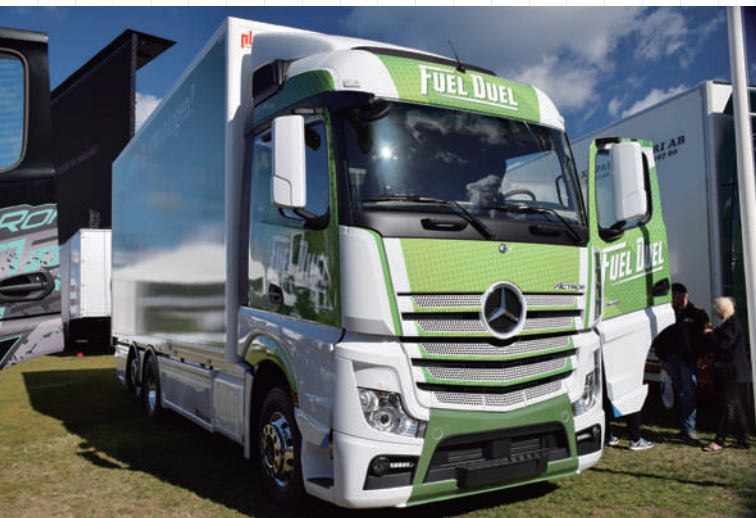
市内配送用途にはディーゼルエンジンベースで軽油及びメタノールの双方が使用可能な Mercedes Benz FuelDuel 車
