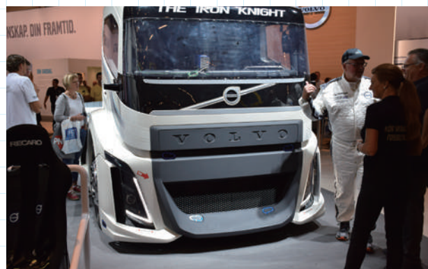
話題を集めた大型トラックによるスピード記録挑戦車。パワートレインの中核部品以外は全て手作りの一品車
