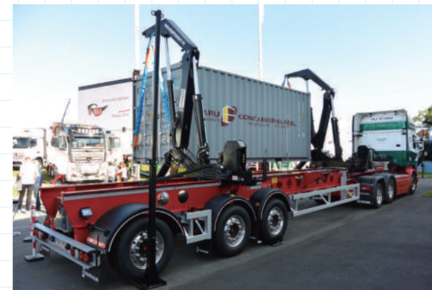
Hammer Maskin 社のコンテナ・サイドローダー。新 SOLAS 条約で、全てのコンテナに総重量申告を義務づけることになったが、これはハマーのサイドリフターにとって何ら影響することではない。重量センサーを備えた前後一組の吊り上げフックが即座に総重量を実測して表示するからである。積載重量 36 トンのセミトレーラには一組で自重 7 トン未満のクレーンを備え、クレーンはコンテナの長さに応じて前後にスライドが可能のように架装されている
