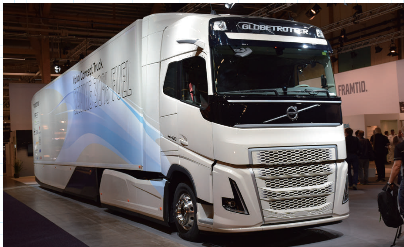
Volvo コンセプトトラック。燃費改善に大きく貢献したのはこの空力特性だ
