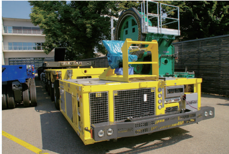
HDMの動力源はこうしたパワーモジュールPMが組み合わされる
