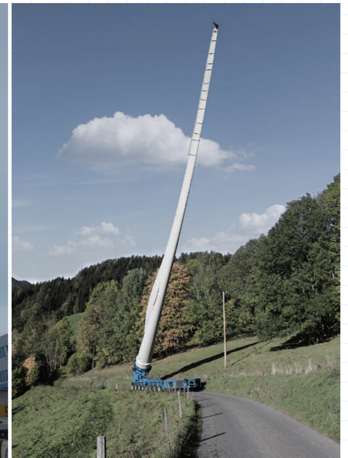
Rの小さい道路で倒して積載しては曲がれない場所ではこのように大きく仰角をつけて周囲との干渉を回避する(G)
