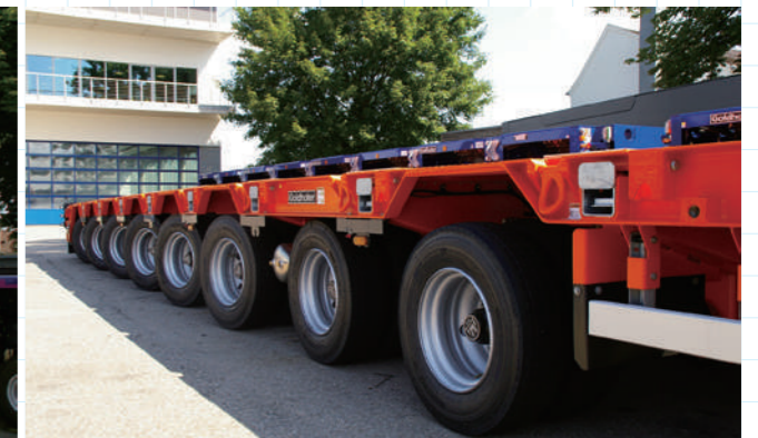
一見、多軸ながら一般的セミトレーラに見えるが、セミトラクタからの油圧供給でステアリングと治陸駆動機能が搭載されている
