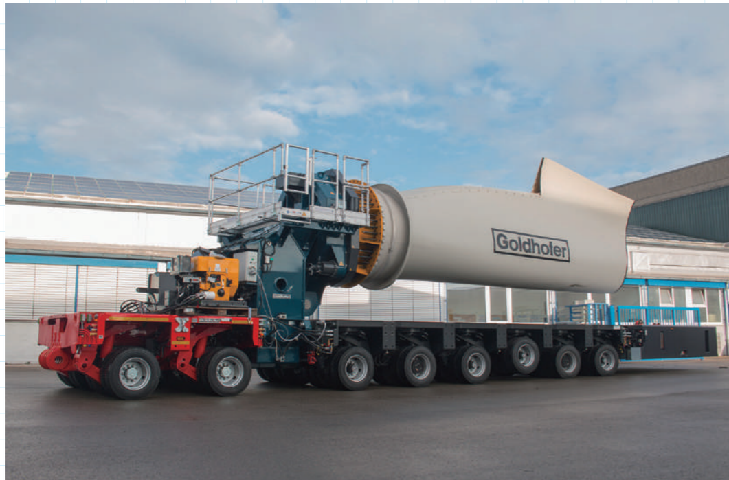
目下需要が伸びている超大貨物(この場合は風力発電用ブレードの一部)用トレーラ台車(G)
