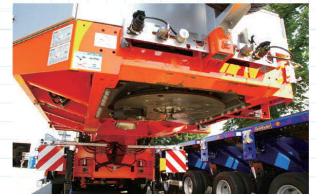
グーネック部分にも通常のセミレには見られない配管と配線が組み込まれている
