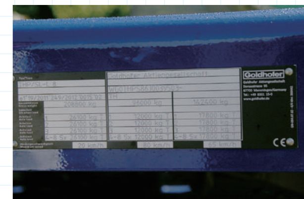
走行速度によって積載重量に格差が設けられている
