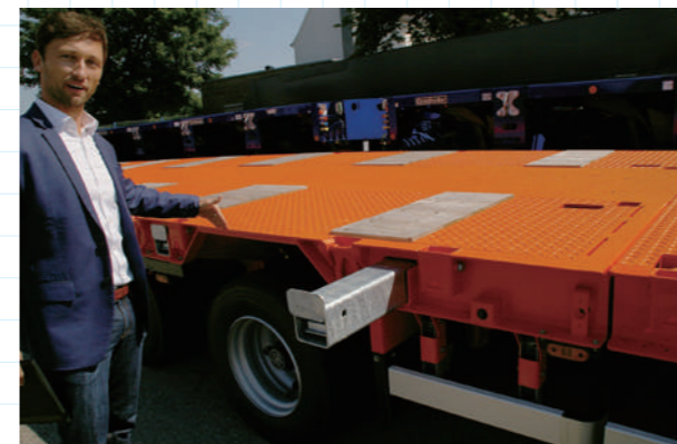
超大貨物の幅方向のみ出しに備えたエクステンションバーも内蔵されている
