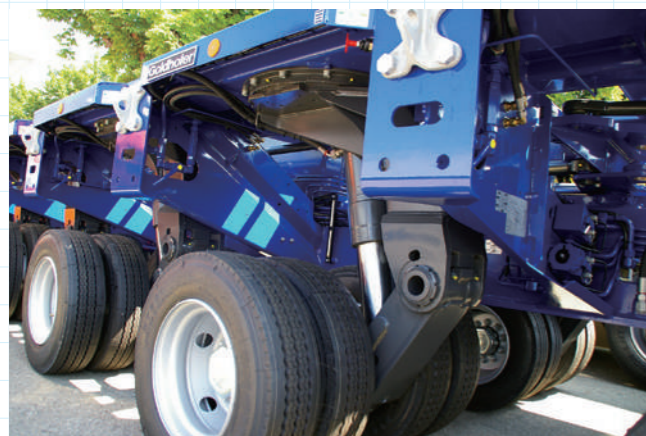
こちらのトレーラは HDM に近い諸機能を搭載している。複輪単位でステア機能を持つ
