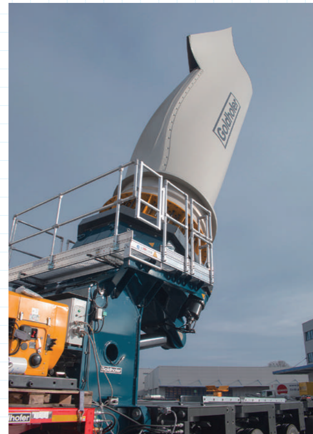
Rの小さい道路で倒して積載しては曲がれない場所ではこのように大きく仰角をつけて周囲との干渉を回避する(G)
