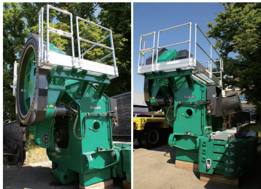
超大ブレードは回転軸への取り付け部分でしか支持出来ないで、このような大きなアタッチメントを必要とする
