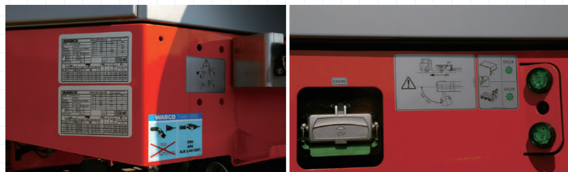
ブレーキ系統は WABCO 製品によるが、一般道路を走行する際の EBS 機能はトレーラ側のステア機能を使用する場合はカップリングの接続変更で機能を殺す。その他の細かい仕様については紙幅の関係で省略するので読者の皆さんで読み解いて頂きたい
