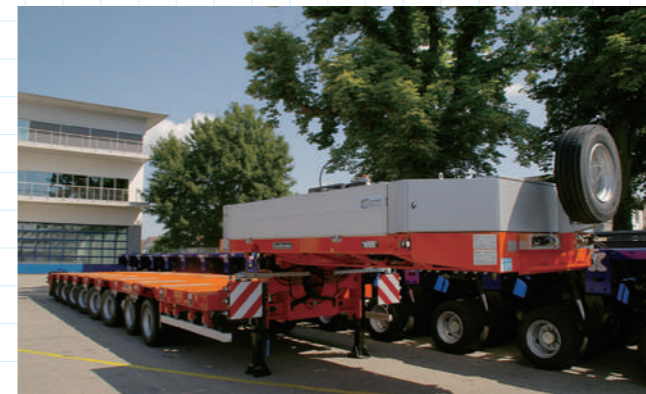
一見、多軸ながら一般的セミトレーラに見えるが、セミトラクタからの油圧供給でステアリングと治陸駆動機能が搭載されている
