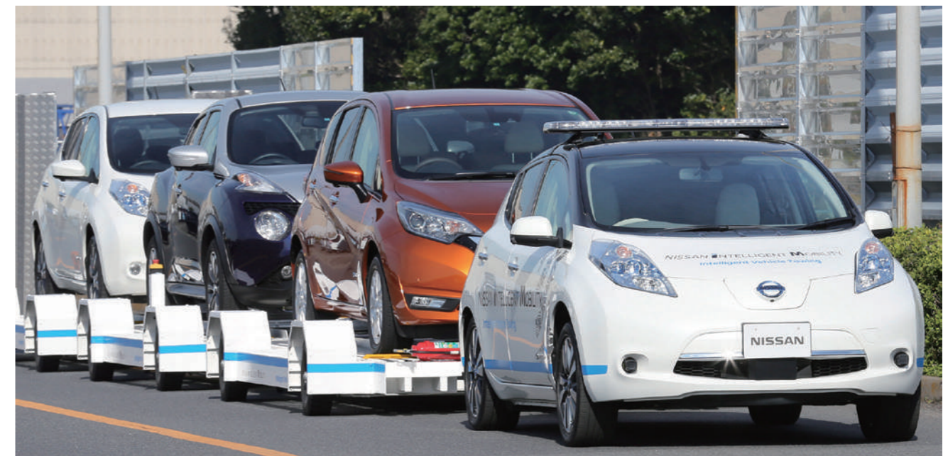
完成車を専用埠頭まで無人で搬送する「Intelligent Vehicle Towing」システム
