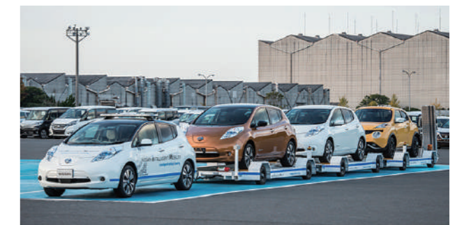
自動運転機能を備えた電気自動車「日産リーフ」ベースの牽引車と台車で構成
