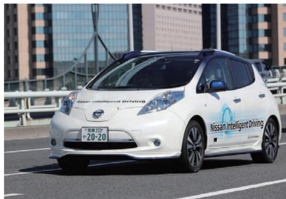
2015年から公道でのテスト走行を行なっている電気自動車「リーフ」をベースとした自動運転実験車
