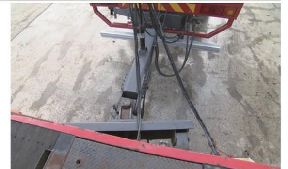
「HIRAKU 式フルトレーラー装置」はフルトレーのバック走行を容易にする佐藤社長が開発したオリジナル装置である
