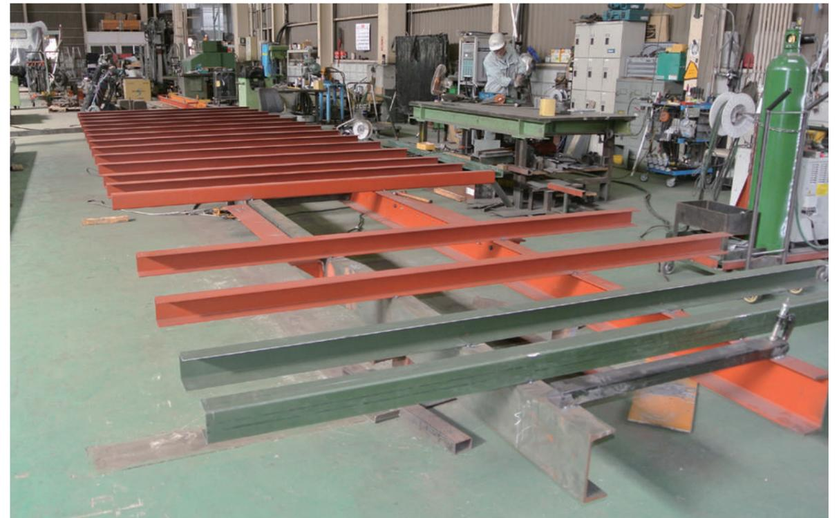
縦根太、横根太の考えではなくシャシを補強するサブフレーム思想が同社のボデー作りの基本である。スウェーデン鋼を採用したサブフレームは車両の剛性を大幅に高める構造になっている
