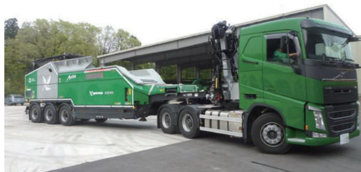
木材破砕機を搭載したトレーラ。トラクタ側にクレーンが搭載されている
