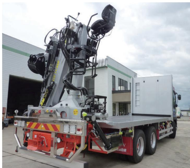
LIVクレーンは酷使に耐える油圧式林業用ローダークレーンだ。フルトラック側に取付けられたタイプである
