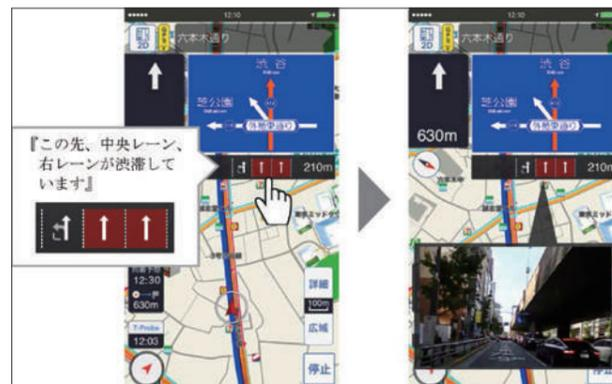
レーン別渋滞情報のスマートフォン表示イメージ: 情報を表示可能な場所に近づくと、渋滞しているレーンを色で表示し、音声で知らせて、タップすると映像がポップアップする
