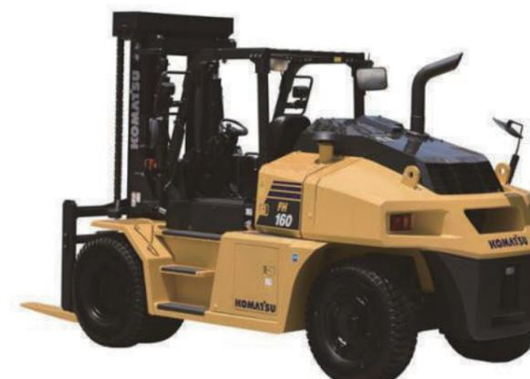
建機油圧制御技術などを取り入れたコマツの油圧駆動式フォークリフト
