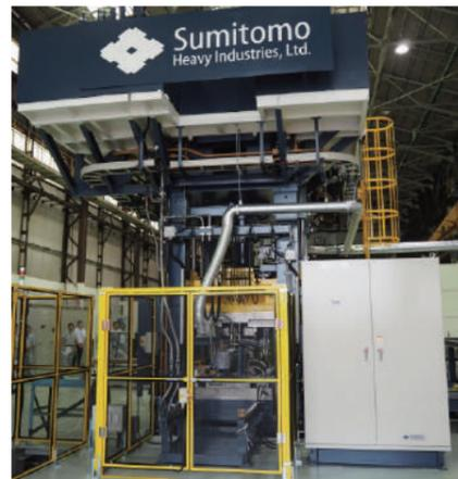
自動車ボディ・フレームの製造システム(STAF)の評価設備
