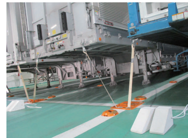
従来型のランディングギアは狭い場所での操作なので重労働で時間もかかる
