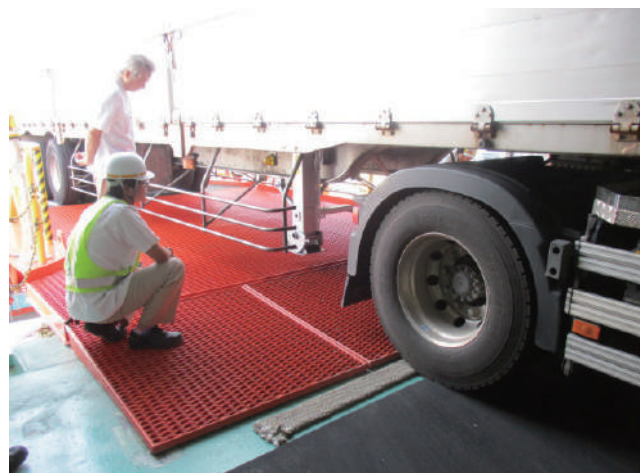
ワンタッチ操作のエア式ランディングは目下テスト中(間もなく終了して本格採用へ)
