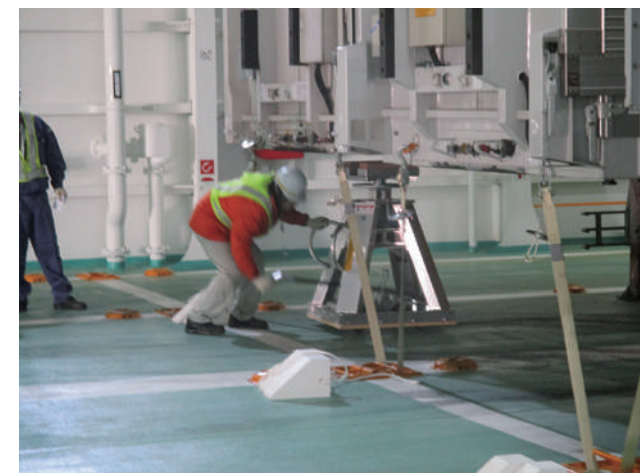
大きな揺れに備えてキングピンに固定するシャーシー台車(エア式補助脚だと不要になる可能性も…)
