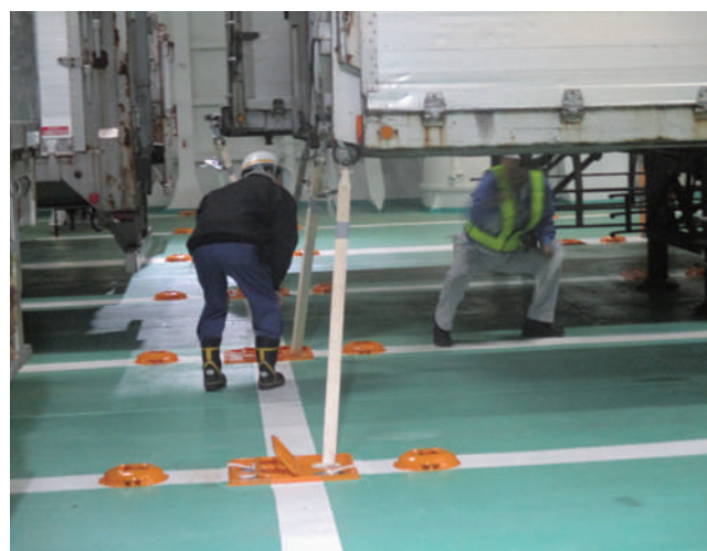
船内でのトレーラ固縛は船のエアで簡単にできる
