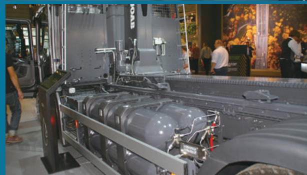
ガスエンジン車の例：SCANIA R450 車。NG タンクは LNG 用で左右に振り分けて搭載されている
