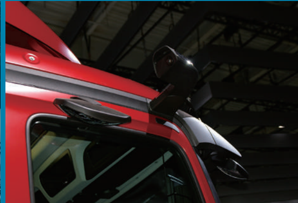
Mercedes Benz Actros 車で採用されるデジタル化した側後方視界モニター用カメラ。キャブ右側直下はなお死角が残るので、ミラーを併用している。なお、キャブ内は左右の A ポスト下部にモニター画面が装着される
