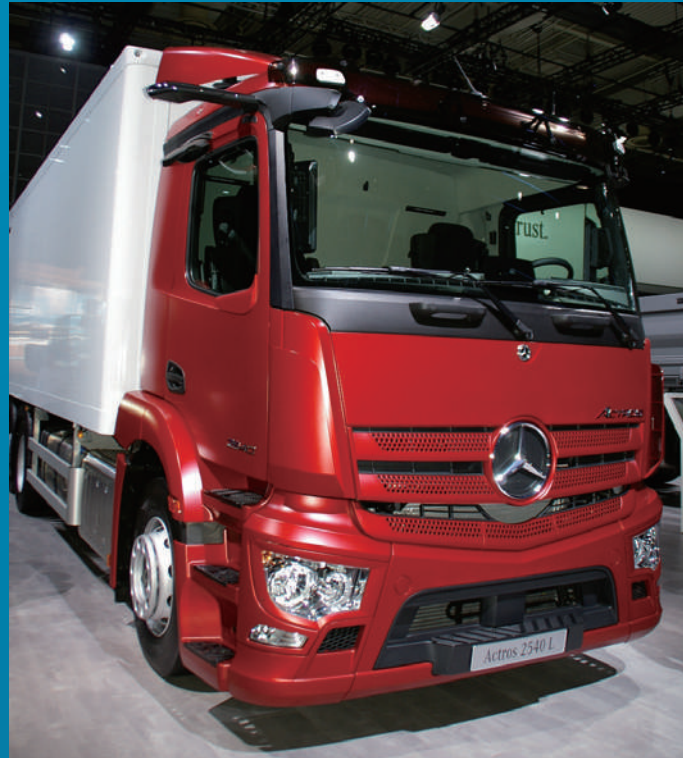
Mercedes Benz Actros 車で採用されるデジタル化した側後方視界モニター用カメラ。キャブ右側直下はなお死角が残るので、ミラーを併用している。なお、キャブ内は左右の A ポスト下部にモニター画面が装着される
