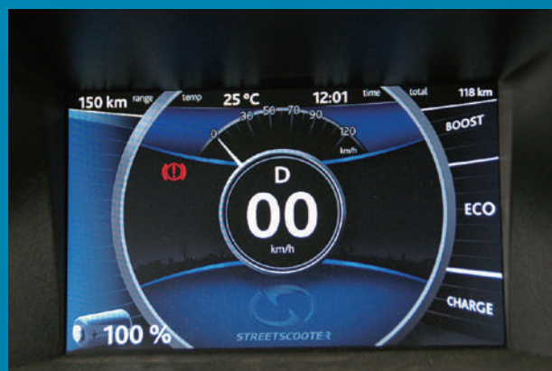
StreetScooter 車の簡素なメータークラスター。停車状態で前進“D”をセレクトした状態。充電は100%、航続距離は150kmと表示されている。実際の交通状況、負荷条件等で表示通りの航続距離が保証されているわけではない。右側には走行中のバッテリーの状態が表示される
