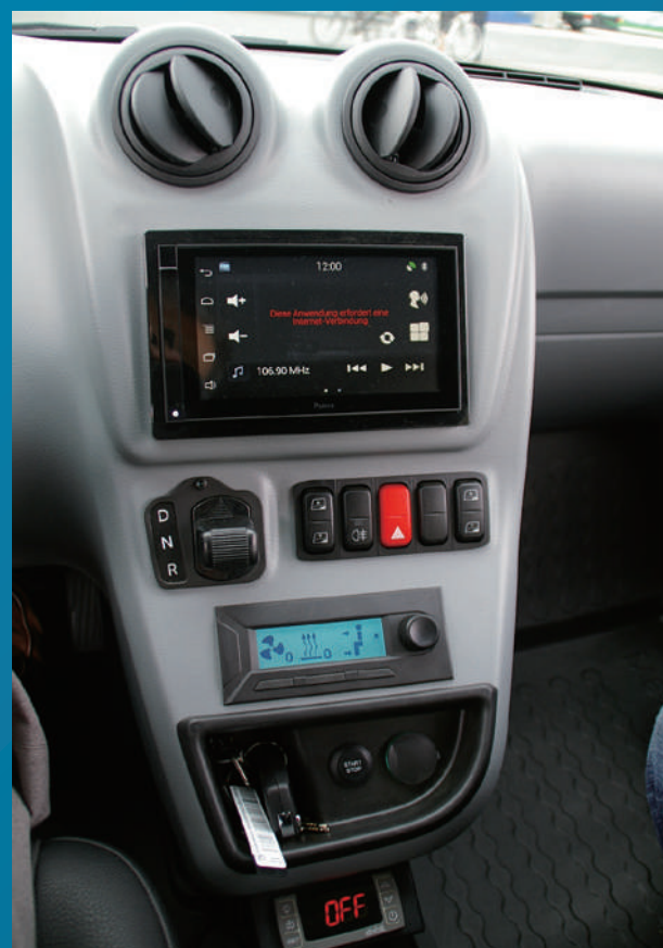
StreetScooter 車のセンタークラスター(標準型)。ディスプレイはタッチパネルで、表示機能の選択操作は全て指先の操作で行う。写真で赤色表示されている言語はドイツ語だが、欧州内の他の言語も選択可能という。特装车で操作選択機能が増加する場合は別途操作盤を設けて対応する
