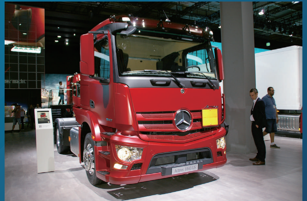
Mercedes Benz Actros 車の在来型アウトサイドミラーの例。彼の地は左ハンドルで右側キャブ直下と右前直下の死角を監視する大きなミラーが必要
