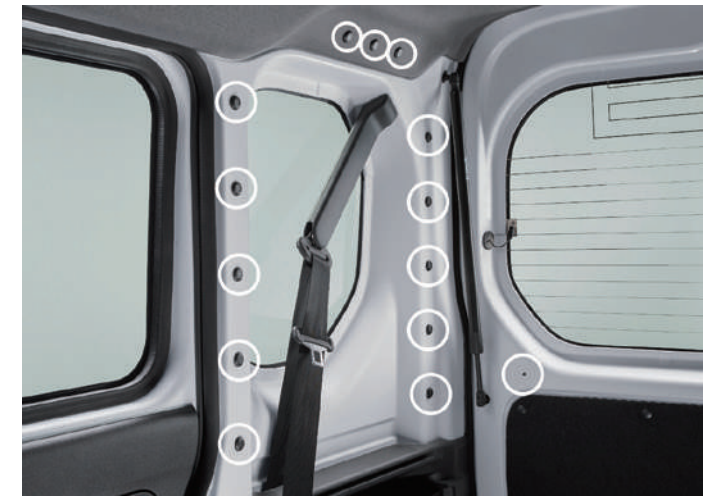
荷室の左右壁面とテールゲートの内側に、合計28個のユーティリティーナットを装備。キャップを外すとM6サイズのネジ穴として使用でき、パイプや棚、金具などを取り付けて空間を自由にアレンジできる
