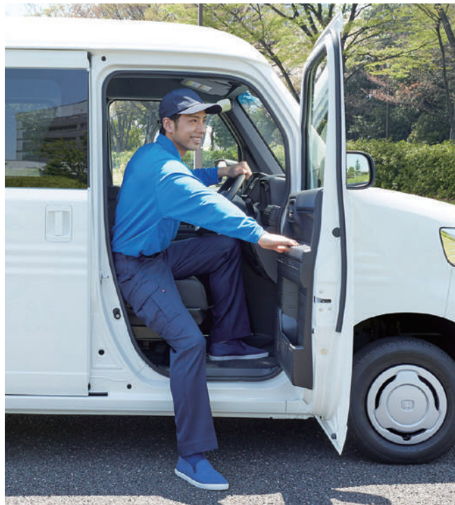
低い床の採用で、スムーズな乗り降りが可能。フロントタイヤの位置を前方に設定し、運転席の足元スペースのゆとりを確保している
