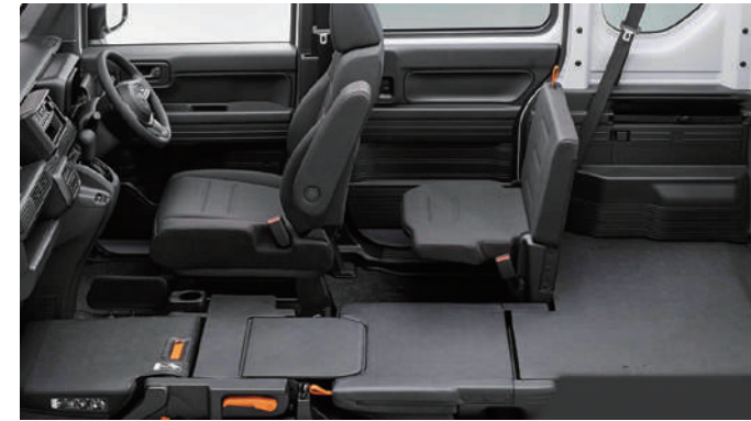
乗車人数や荷物の量などでシートのレイアウトが変更可能だ。(上) 1名乗車時(助手席&荷室フラットモード) / 1名乗車時(助手席テーブルモード) (中) / 2名乗車時(助手席&荷室フラットモード) (下)
