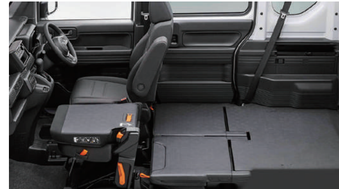
助手席の足元と後方に2個ずつ、荷室フロアに4個、合計8個のフックを装備。ラッシングベルトや紐などで荷物を固定できる
