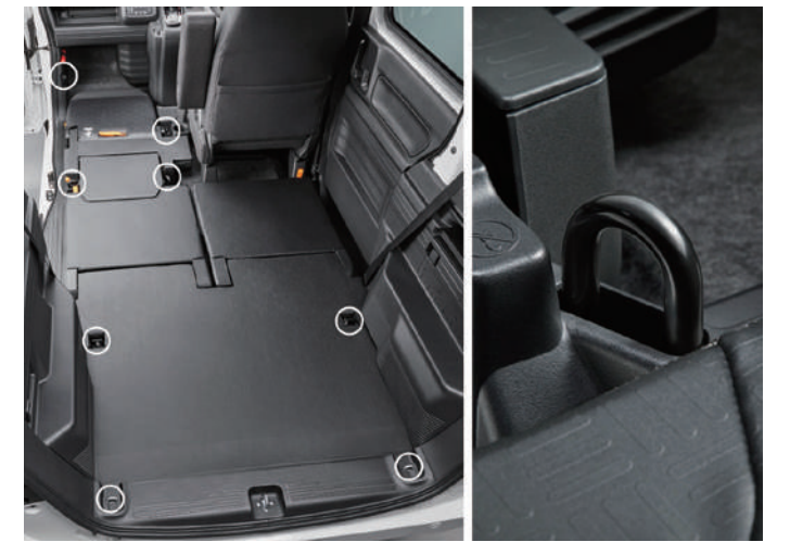
助手席の足元と後方に2個ずつ、荷室フロアに4個、合計8個のフックを装備。ラッシングベルトや紐などで荷物を固定できる
