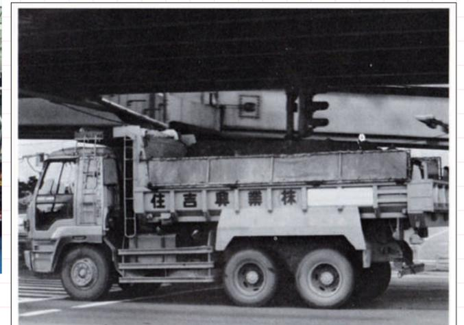
都内の一般道ではこの様に廃土を運ぶダンプが多い。このタイプはかさ上げをせず舟底(荷台左右コーナー面取り)タイプでコボレーンを取り付ける。
