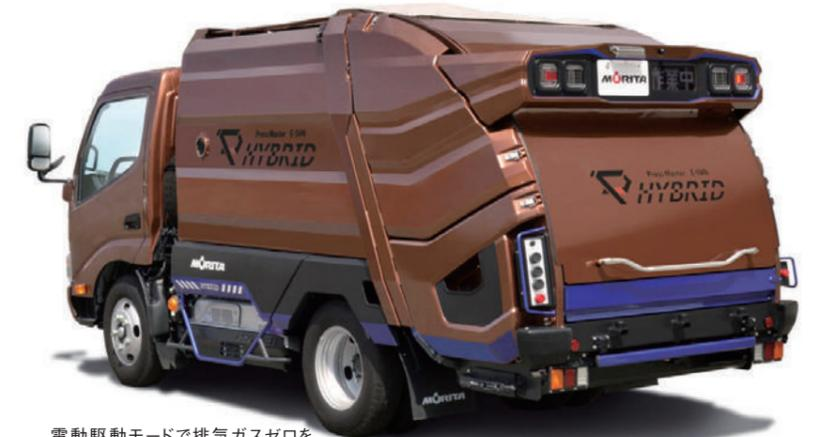
電動駆動モードで排気ガスゼロを実現したプレス式電動塵芥収集車「Press Master E-SVN」
