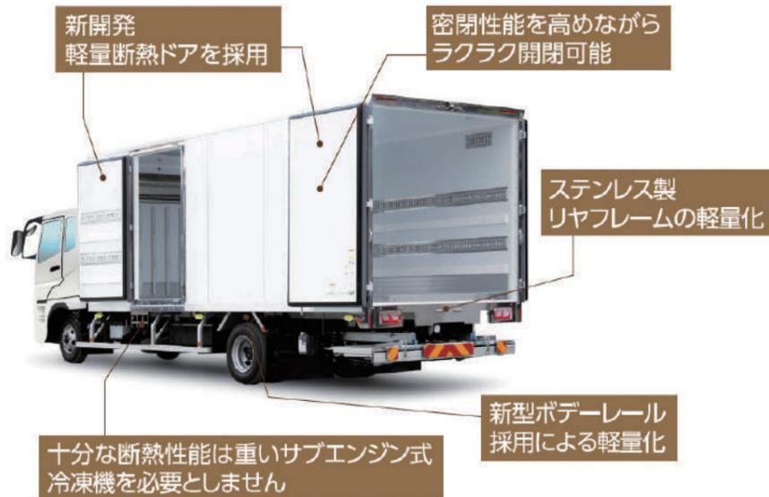
さらに、断熱性の向上を実現しながら、新開発の軽量断熱ドアの採用やステンレス製リヤフレームの軽量化、新型ボデーレール採用による軽量化など、ボデー構造を見直すことでボデー全体の軽量化を行い、積載量のアップも実現させている。
