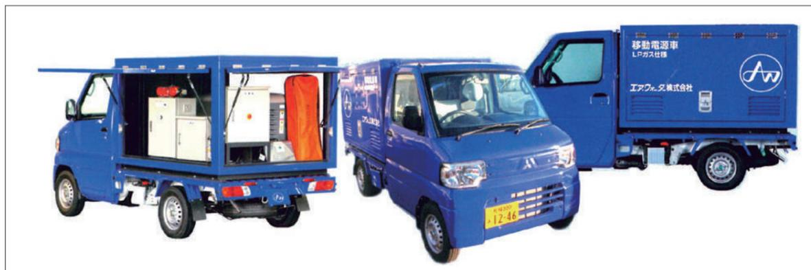
機動性に優れる軽自動車をベースにしたLPガス移動発電車(20kVA)
