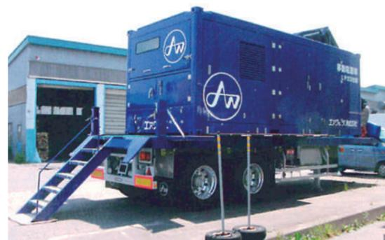
トレーラタイプの設置型LPガス移動発電車(125kVA)
