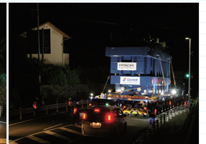
あの歩道橋も無事通過。「今夜の主役」はなお日立港区第四埠頭へ向かって微速運行を続ける。通過後、歩道橋は素早く元の通常の高さに降ろされる
