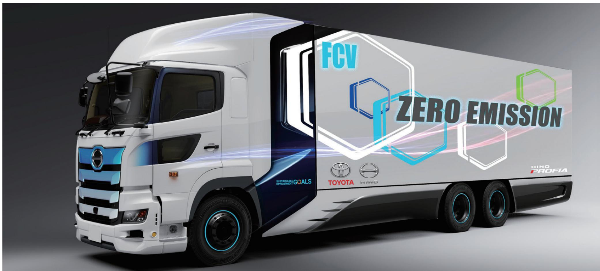
新開発されるトヨタFCスタックを2基搭載し、日野の強みである大型車ハイブリッド技術を応用した車両走行制御を組み合わせる。航続距離は600kmを目標とし、環境性能と商用車としての実用性を高次元で両立することを目指す、としている。
