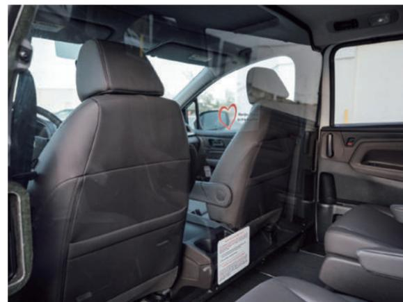
搬送時の感染リスクを削減するため運転席と後部座席に仕切りを設置されている
